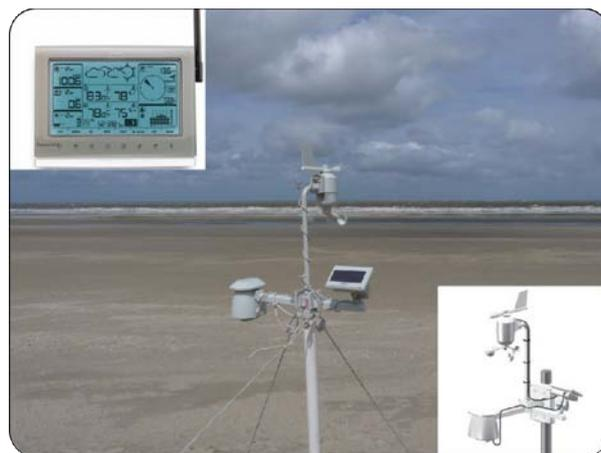
Figure 2.20. Station météorologique *Professional Oregon Scientific WMR 200* : data logger, capteurs, et photographie sur le terrain (Photographie A.Tresca)
