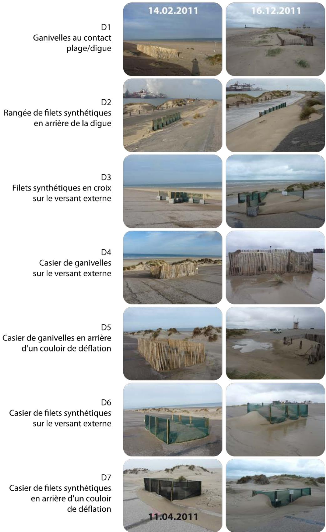
**Figure 6.40 Photographies des structures de captage du sable installées en arrière des dunes de pied de digue le 14.02.2011 (11.04.2011 pour D7) et le 16.12.2011 (clichés Tresca)**
