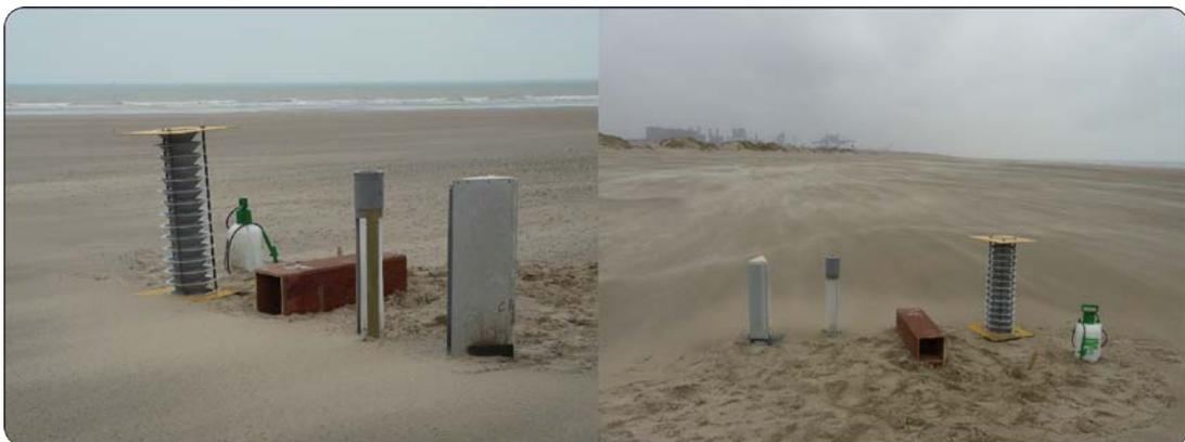
Figure 2.18. Photographies de l'expérimentation de terrain visant à comparer différents types de pièges à sable (Photographie A. Tresca, 14.01.11)
