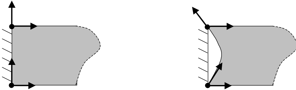
FIG. III.12 – Conditions aux limites mal imposées sur un encastrement.
