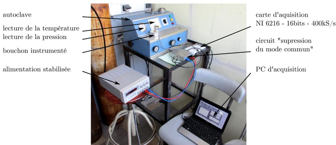
**FIGURE 5.7 : Dispositif expérimental** - Photographie présentant l'autoclave et le montage expérimental utilisé au cours de l'étape de séchage super-critique. Source : photographie personnelle.
