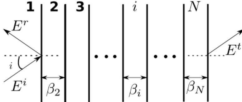
FIGURE 2.12: Réflexion et transmission d'un champ électromagnétique sur et à travers une structure multi-couche composée de  $N$  films minces.  $\beta_i$  représente le chemin optique parcouru par l'onde transmise à travers le film  $i$ .
