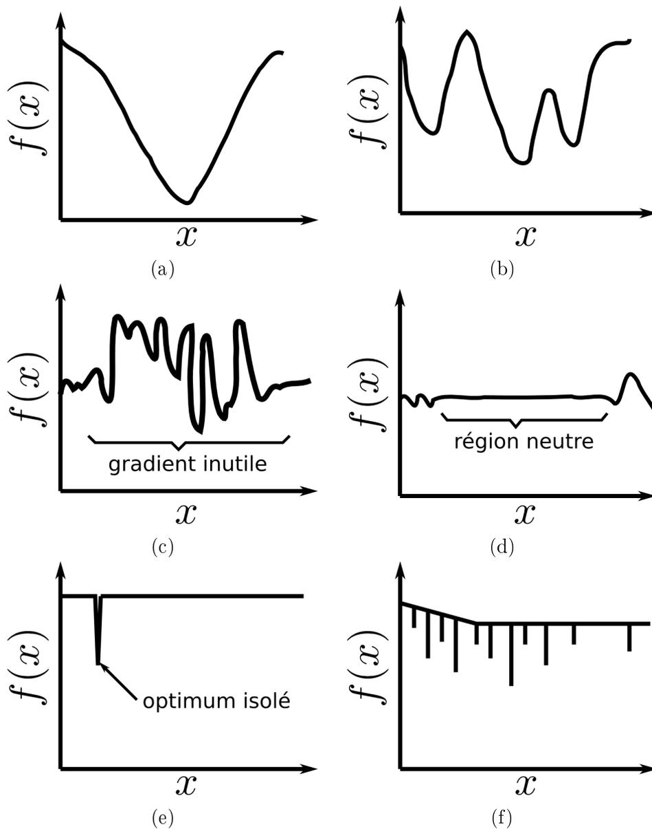
FIGURE 4.1: Différents facteurs de difficulté pour la minimisation d'une fonctionnelle  $f$  : la multimodalité, *i.e.* la multiplicité de minima locaux (b), une forte irrégularité (ou encore « rugosité ») (c), la neutralité (d), l'épistasie (e), ou encore la combinaison de plusieurs de ces facteurs, ici épistasie et multimodalité (f). La figure (a) représente un problème « facile » où il s'agit d'optimiser une fonction continue, dérivable et fortement convexe présentant un seul optimum.
