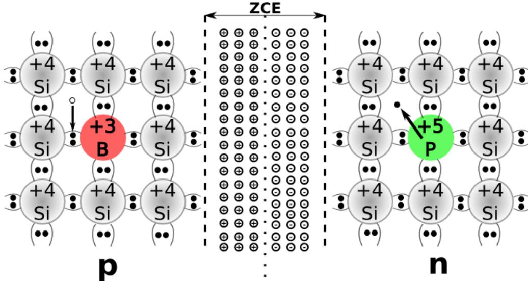
FIGURE 3.2: Schématisation de la création de porteurs majoritaires par introduction d'impuretés et de la ZCE par les charges fixes aux bords de la jonction.
