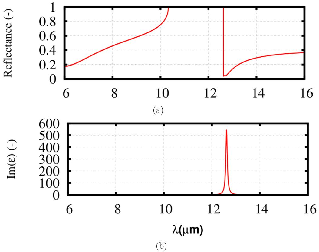
FIGURE 5.8: La réflectance d'un film mince de germanium sur un substrat transparent fictif (a) et le coefficient d'absorption du SiC,  $\text{Im}(\epsilon)$  (b). Le minimum de la réflectance correspond à la longueur d'onde de résonance du coefficient d'absorption du SiC.
