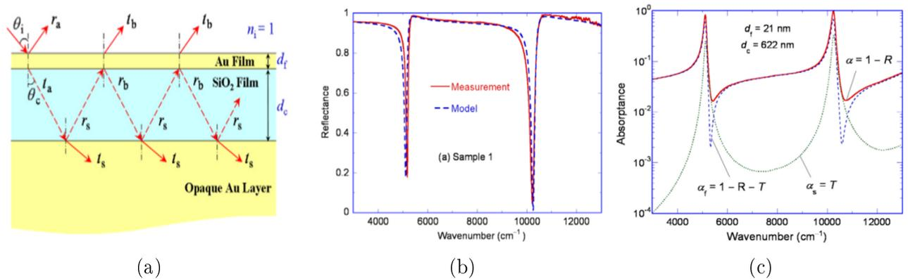
FIGURE 5.6: Cavité Fabry-Pérot résonnante asymétrique (a), sa réflectance (b) et son absorptivité (c) à incidence normale. (Source : Wang et al. [2009])
