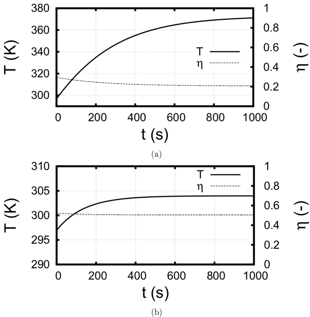
FIGURE 3.12: Évolution de la température et de l'efficacité d'une cellule en silicium exposée à un rayonnement d'un CN à 5800 K (a), et à celui d'un ES (b) dans un environnement à température ambiante de  $25 \text{ }^\circ\text{C}$  avec une émissivité modélisée par une fonction porte de largeur  $0,2 \mu\text{m}$  entre  $0,7 \mu\text{m}$  et  $0,9 \mu\text{m}$ . On considère un facteur de forme unité de l'ES à la cellule.
