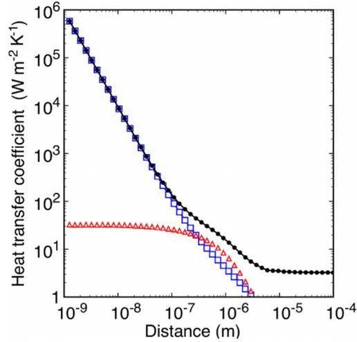
FIGURE 6.2: Contribution évanescence du coefficient d'échange pour les polarisations  $p$  (carrés) et  $s$  (triangles) en fonction de la séparation entre les deux milieux semi-infinis en SiC à 300 K ainsi que le coefficient d'échange total (points). (Source : [Rousseau et al. \[2012\]](#))
