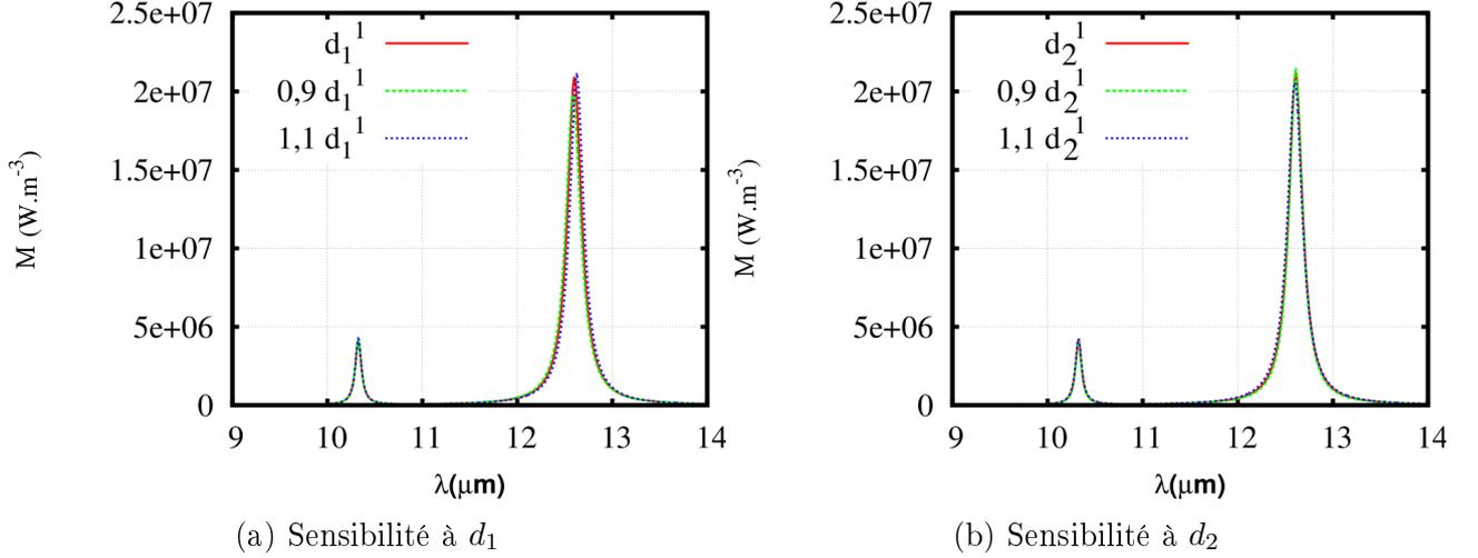
FIGURE 5.18: Émittance hémisphérique d'un ES bi-couche (Tableau 5.1,  $n^\circ 1$ ) avec une variation de  $\pm 10\%$  des dimensions des deux couches.  $d_i^1$  figure l'épaisseur de la couche  $i$  de la structure.
