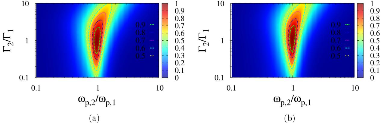
FIGURE 6.6: Flux radiatif en champ proche entre deux plans semi-infinis de matériaux différents dont les permittivités diélectriques sont modélisées par un modèle de Drude, en fonction du rapport des pulsations plasma et des coefficients d’amortissement. Résultats obtenus par calculs asymptotique (a) et par calcul direct (b).
