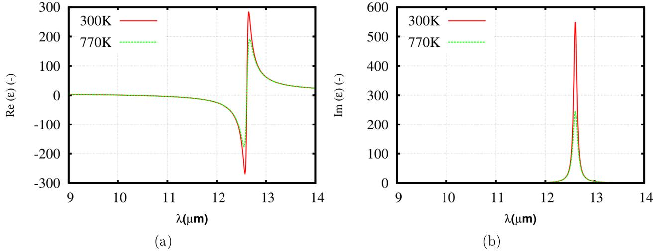
FIGURE 2: Partie réelle (2a) et imaginaire (2b) de la permittivité diélectrique du SiC à 300 K et à 770 K.
