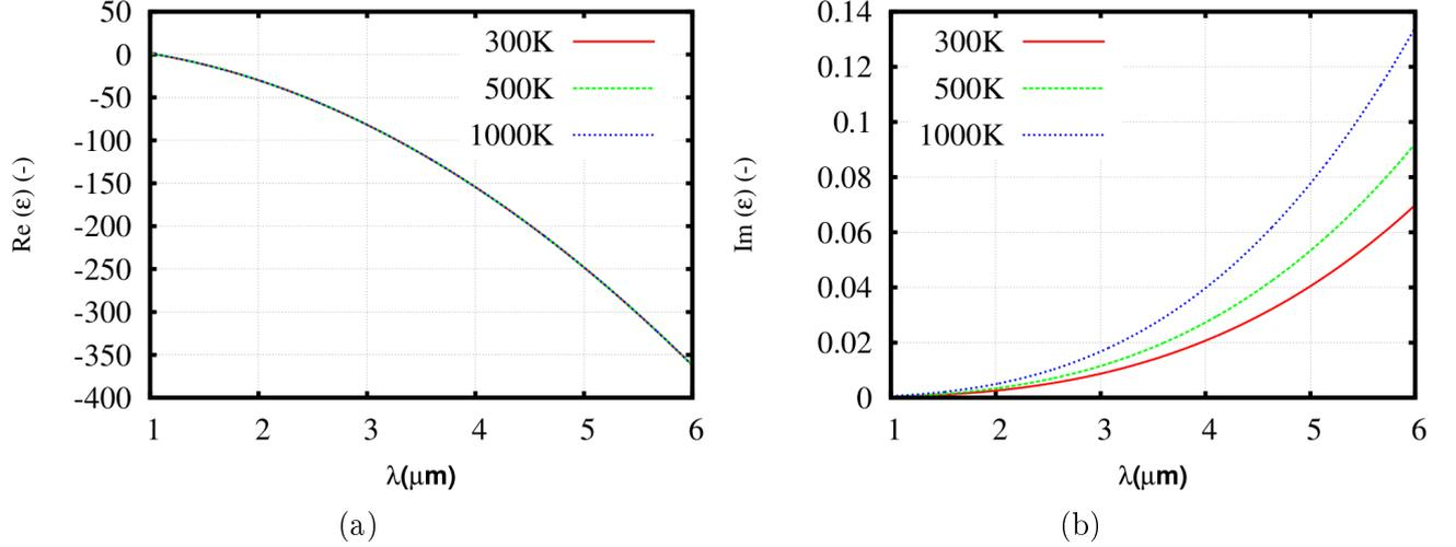
FIGURE 1: Partie réelle (1a) et imaginaire (1b) de la permittivité diélectrique du silicium dopé  $p$  à  $10^{20}$   $\text{cm}^{-3}$  pour des températures de 300 K, 500 K et 1000 K.
