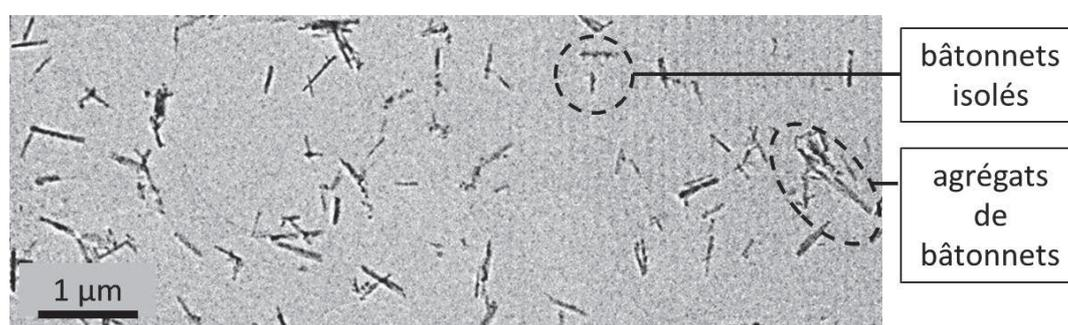
Figure 45 : Clichés de cryo-MET montrant l'état de dispersion du système GS53 ( $R=2\%$ ) après 48h de vieillissement. Les échantillons ont été préparés à partir de suspension contenant  $100 \text{ mg.L}^{-1}$  de particules anisotropes (goéthite ou boémite). Les dilutions ont été réalisées à pH et forces ioniques équivalentes.
