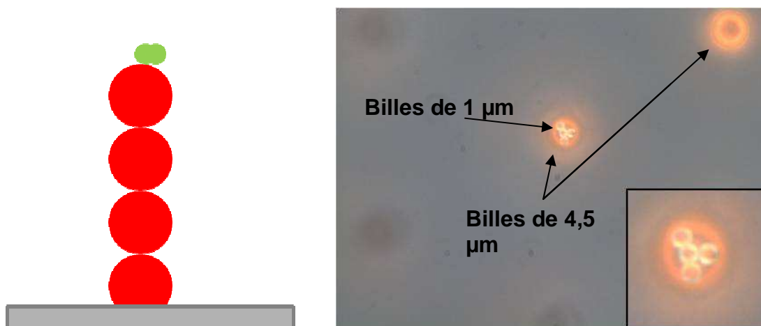
Figure 19 : A gauche : schéma de côté d'une colonne de billes de 4,5\ \mu\text{m} surmontée de billes de 1\ \mu\text{m} . A droite, une telle colonne vue de haut. En encart, un zoom sur la bille de 4,5\ \mu\text{m} ornée de billes de 1\ \mu\text{m} .
