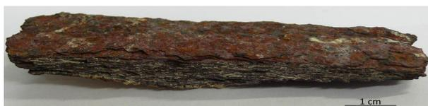
**Figure 1.10 :** Échantillon de couches de produits de corrosion provenant du Palais des Papes en Avignon.
