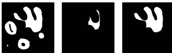
**Figure 2.19** – Exemple de reconstruction morphologique d'une image binaire. De gauche à droite : l'image initiale ( $400 \times 400$  pixels), l'érodé par un disque de 20 pixels de rayon, et la reconstruction morphologique de l'érodé dans l'image initiale, permettant de retrouver le gros objet initial et d'éliminer les petits objets.
