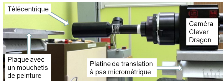
FIGURE 2.8: Montage utilisé pour mesurer l'influence d'un déplacement hors plan de la caméra Clever Dragon avec son télécentrique sur la mesure des champs de déplacements. La caméra est placée sur une platine de translation dont la précision est d'un micromètre. Le même montage a été utilisé pour mesurer l'influence d'un déplacement hors plan avec la caméra Leutron.
