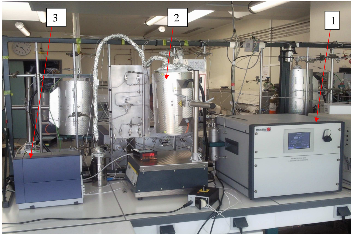
Figure III.2 : Montage expérimental pour la réaction de vaporeformage du méthane
