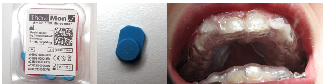
Figure 45: Puces électroniques pour évaluation de l'observance, validées pour une utilisation intrabuccale (Theramon TM ) a) norme CE b) gros plan (diamètre 4mm) c) illustration clinique, capteur inclus dans une bielle de Herbst
