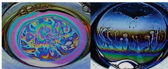
Figure 6.26: Écoulements photo-induits dans une cellule de mousse élémentaire.
