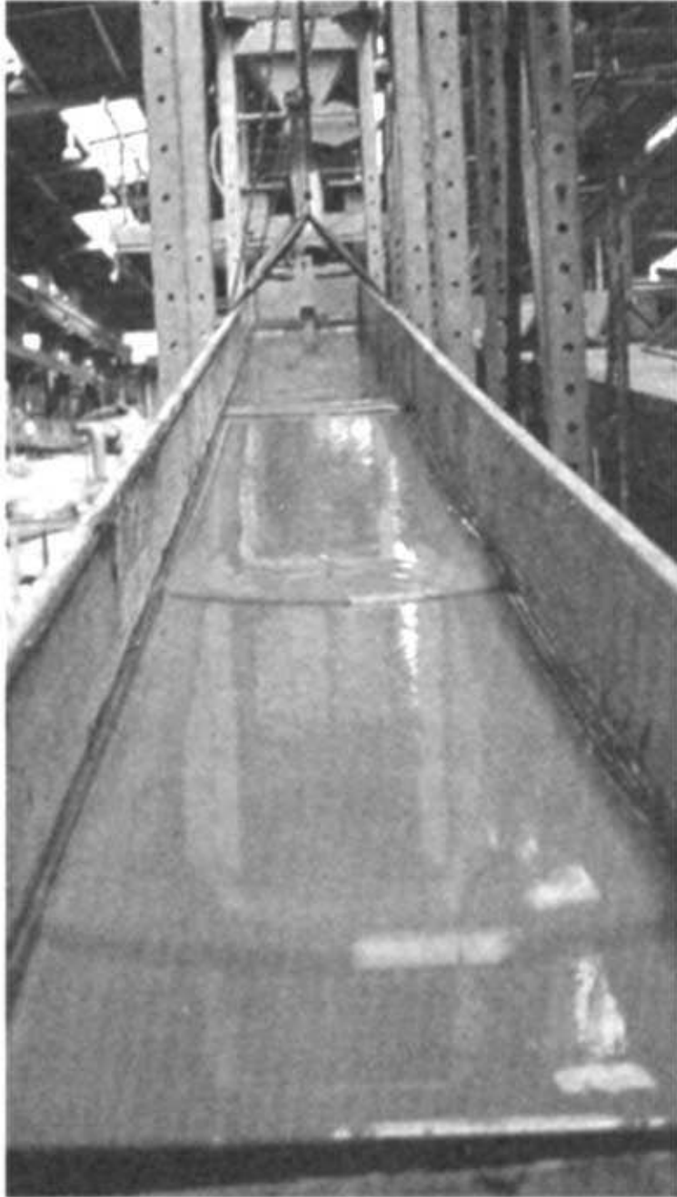
Figure A.9: Observation d'ondes à rouleaux dans un écoulement d'un mélange d'eau et de kaolinite, tiré de Coussot [29].
