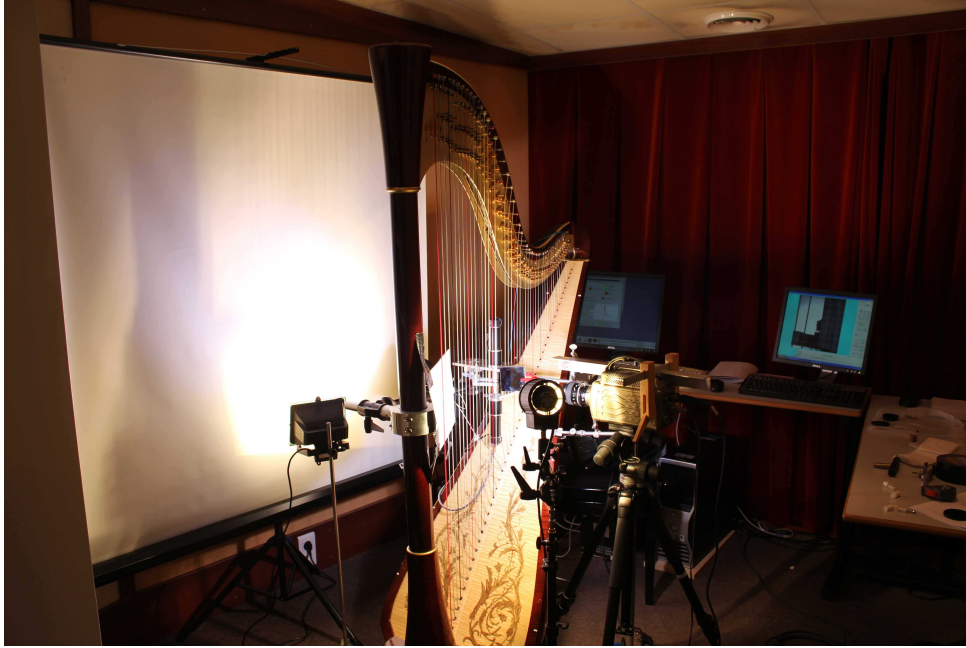
FIGURE 5.11 – Photographie du montage expérimental lors de l'évaluation des performances du doigt artificiel.
