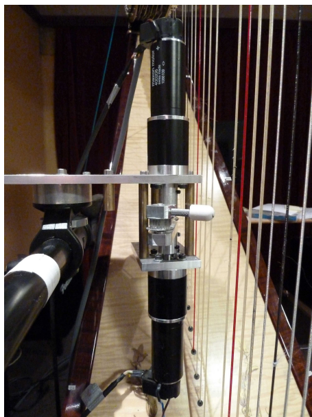
FIGURE 5.10 – Photographie du doigt artificiel mis en place sur une harpe de concert afin d'en pincer les cordes.
