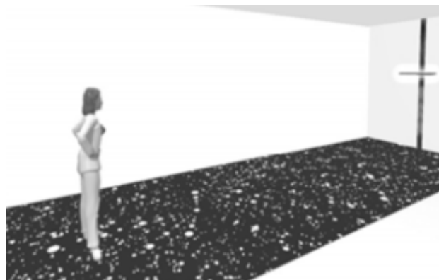
Figure 46. Dispositif expérimental de franchissement statique dans lequel les sujets doivent estimer à partir d'un point d'observation fixe s'ils pensent passer sans se pencher sous une barre dont la hauteur varie (d'après Marcilly et Luyat, 2008).
