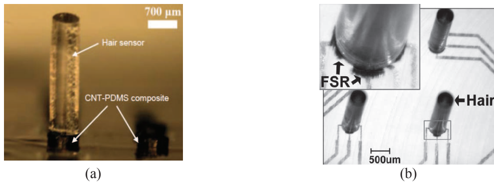
Figure I-12 : Capteur de force développé par Engel et al (a) Elément d'une matrice de capteur développé par Han et al (b).
