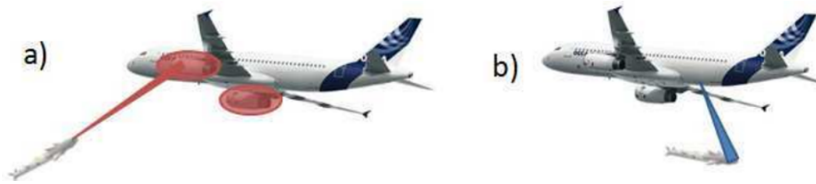
FIGURE 1.2 – Schéma de principe de la contre mesure optique. (a) Le missile détecte une source de chaleur (b) Le missile est dévié de sa trajectoire après avoir été ébloui par une source optique.
