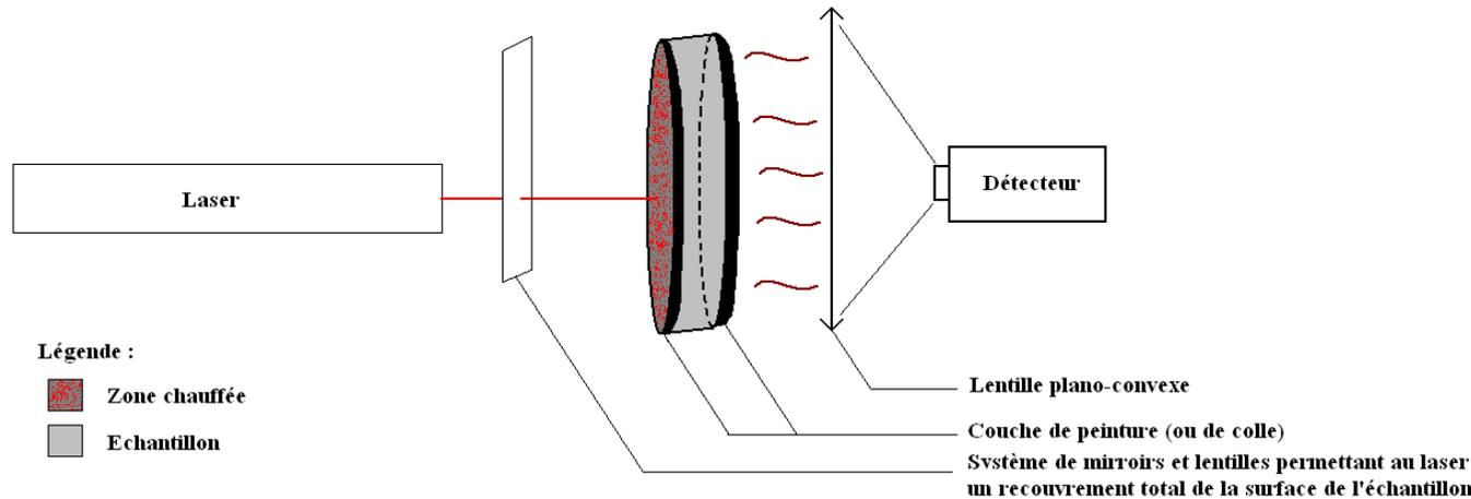
FIGURE 2.2.: Schéma de principe de la méthode flash
