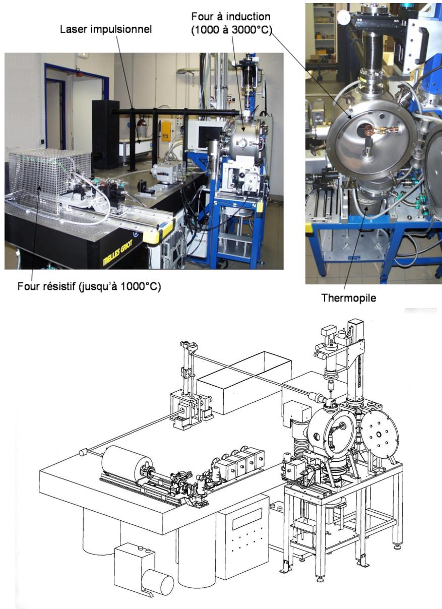
FIGURE 3.1.: Banc d'essai pour réaliser la méthode flash
