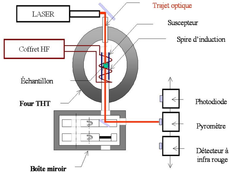
FIGURE 3.2.: Schéma du banc d'essai pour réaliser la méthode flash
