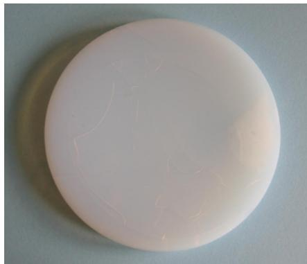
FIGURE 3.8.: Un échantillon d'aérogel de silice
