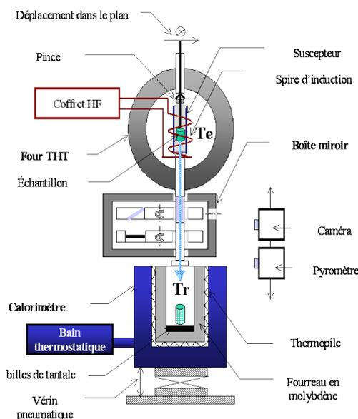
FIGURE 3.3.: Dispositif de mesure de la capacité calorifique
