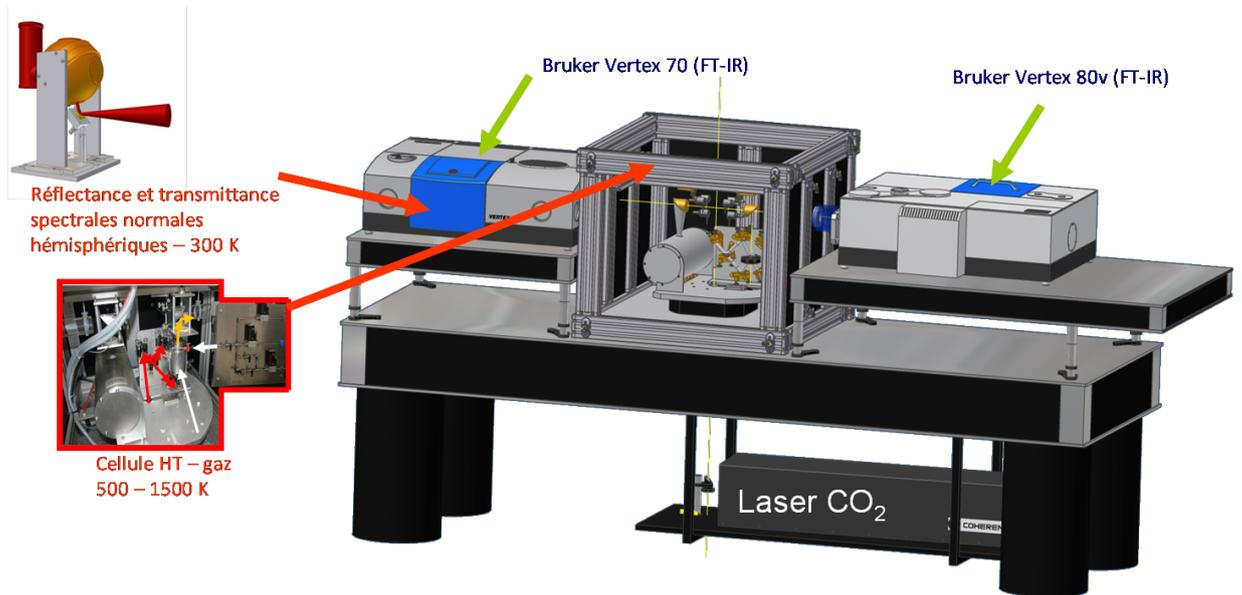
FIGURE 3.4.: Dispositif de mesure de l'émittance spectrale
