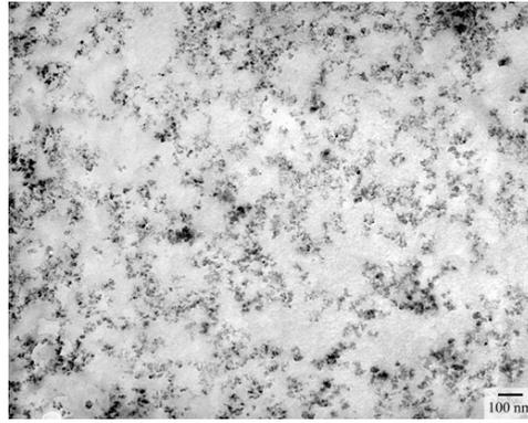
FIGURE 3.9.: Cliché MEB d'un aérogel de silice
