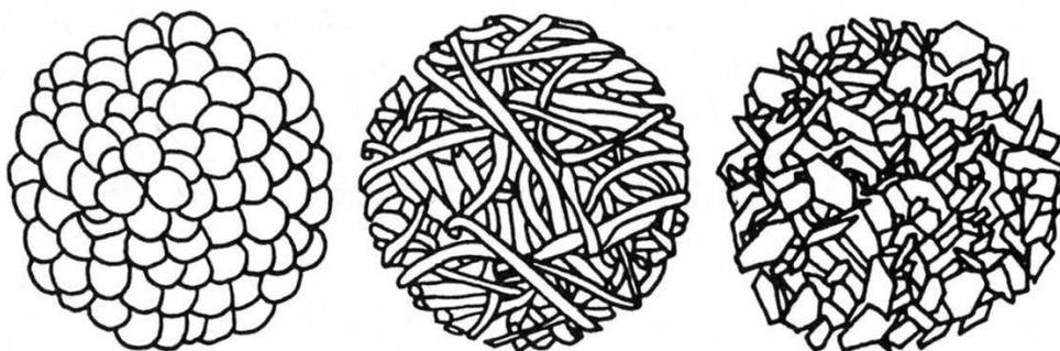
Figure 67 : Exemples d'agrégats, de sphères, de fibres ou de plaquettes, dont la surface spécifique et la taille moyenne de pores sont indépendantes de la taille de l'agrégat
