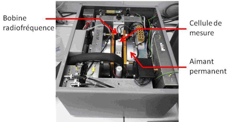
Figure 18 : spectromètre Maran Ultra 0,54T
