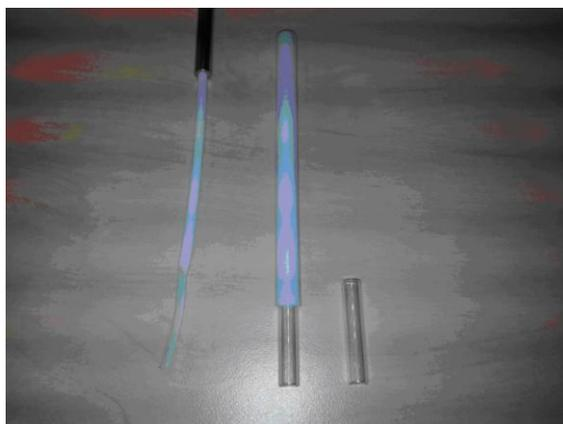
Figure 21 : Tige d'agitation et tube RMN
