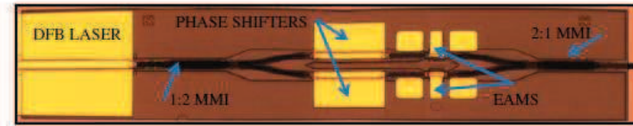
Figure 2-9 : Architecture d'un laser EML pour les formats de modulation complexes [42].
