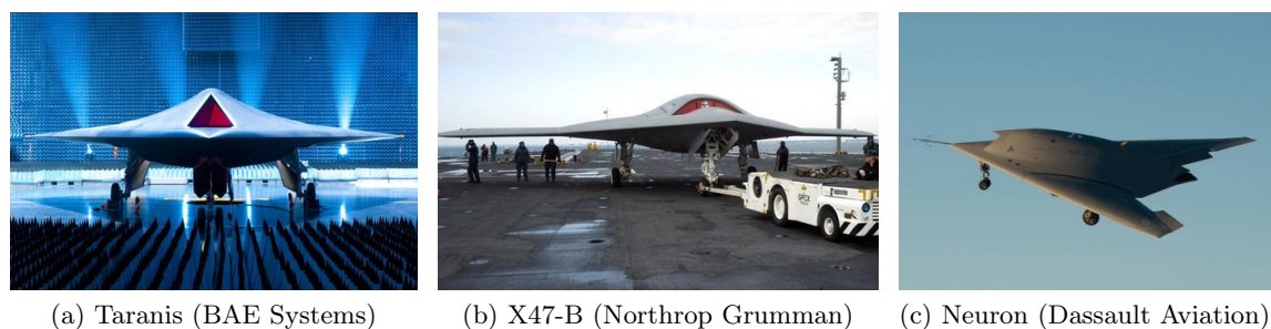
FIGURE 1.6 – Drones d'attaque furtifs caractérisés par une architecture d'aile volante
