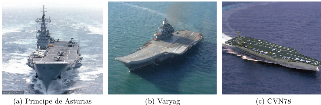
FIGURE 1.9 – Catégories de porte-avions : porte-aéronefs (a), STOVAR (b), CATOVAR (c)
