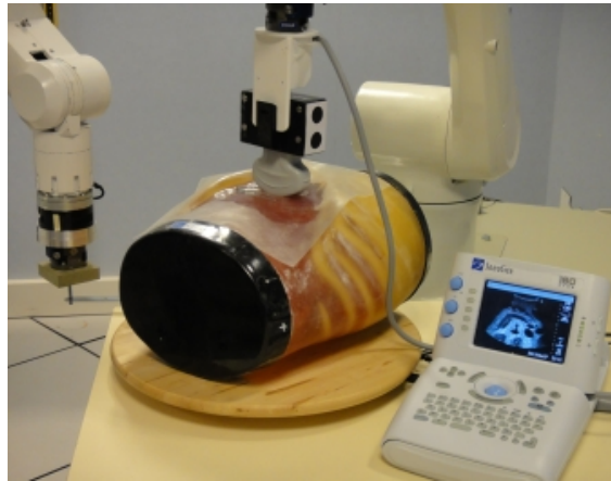
FIGURE 4.11 – Dispositif expérimental utilisé pour valider la tâche de compensation du mouvement sur un fantôme abdominal. Le mouvement de perturbation est réalisé en appliquant une rotation contrôlée à un plateau tournant sur lequel est posé le fantôme.
