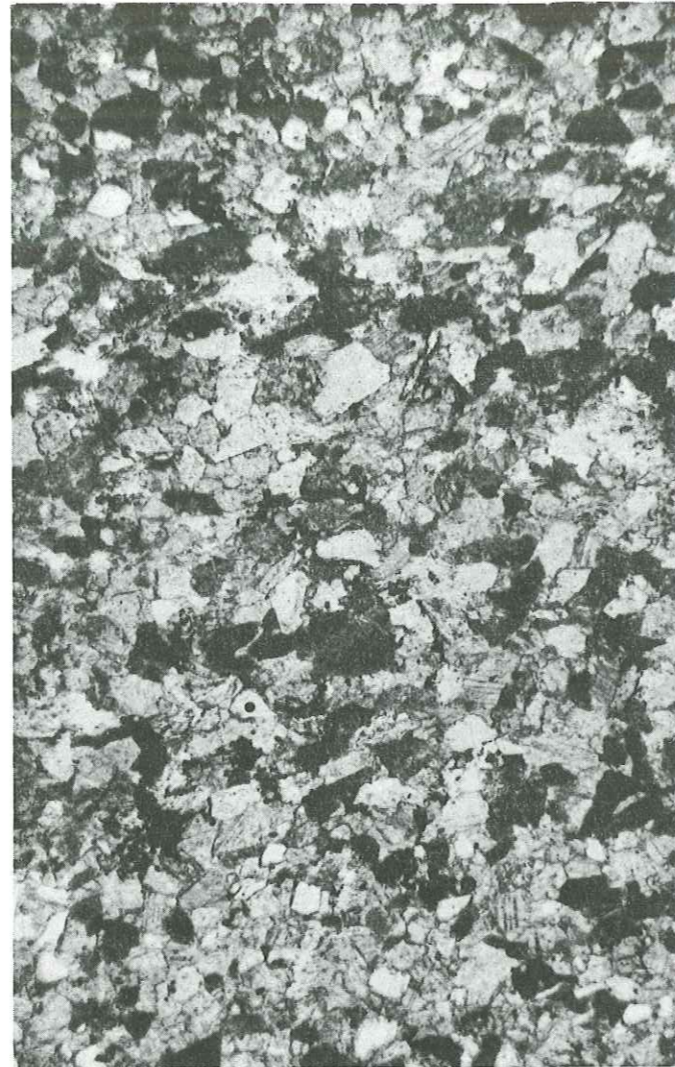
Photo 20. Calcaire gréseux et graveleux de l'Oligocène du Barroux. Quartz, plagioclase et micas. \times 50 .
