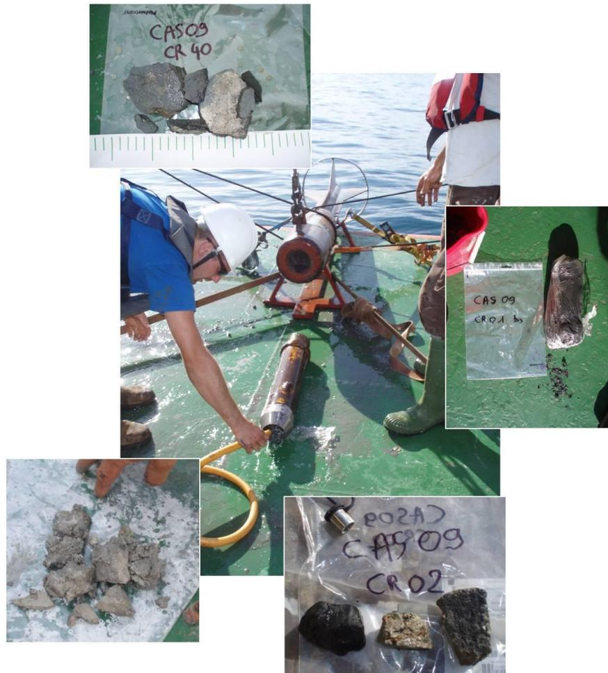
Figure 5- 1: Carottier à roche de type CNEOX-VILLE utilisé lors de la campagne CASSEIS (2009) et photos de quelques échantillons carottés sur le fond marin.
