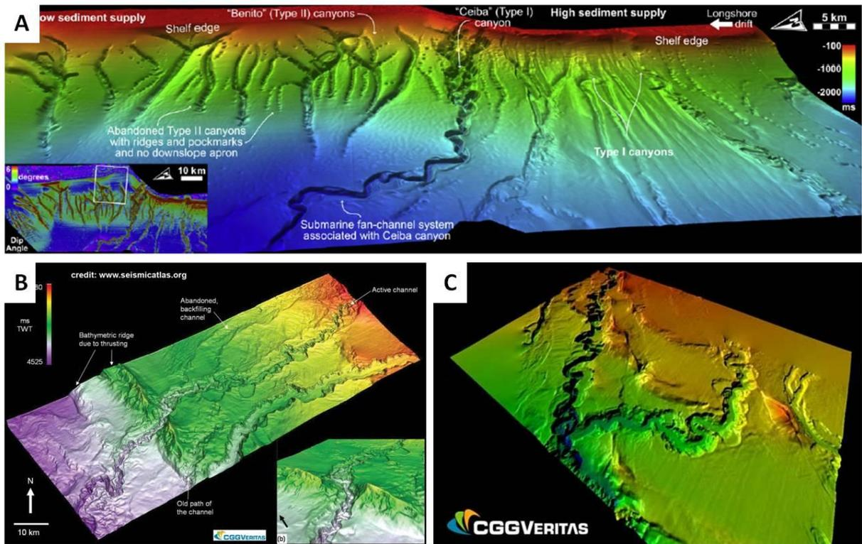
Figure 2- 16 : Cartes du fond marin en temps (ms TWTT) illustrant des canyons sous-marins interprétées d'après des données de sismique réflexion. A : Canyons sous-marins au large de la Guinée Equatoriales (Jobses *et al.*, 2010) ; B et C : Canyons sous-marins au large du delta du Niger (d'après Virtual Seismic Atlas [http:// www.seismicatlas.org](http://www.seismicatlas.org)).
