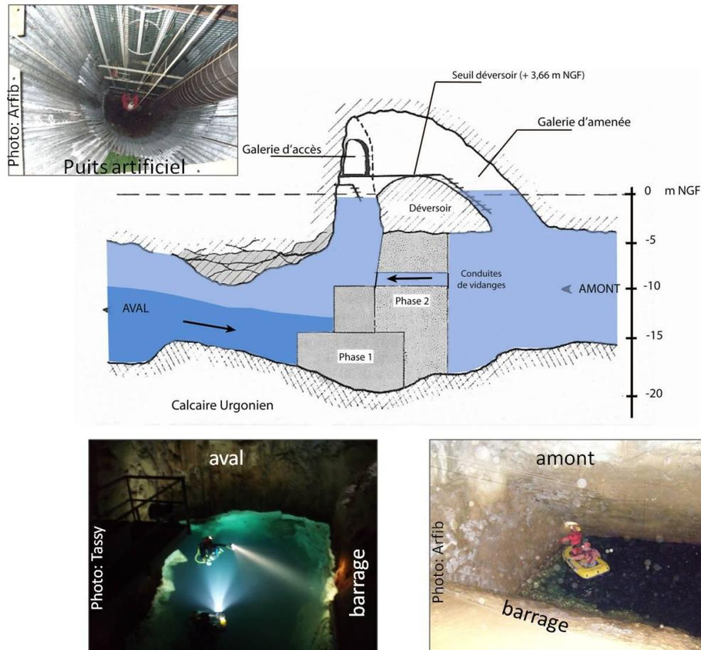
Figure 4- 6: Schéma en coupe du barrage de Port-Miou obstruant partiellement la galerie naturelle (Cavallera, 2007). A l'aval, la langue d'eau de mer salée, plus dense que l'eau de la source est concentrée dans la partie inférieure du conduit noyé. A l'amont, l'eau de la source est saumâtre. La galerie artificielle permettant l'accès terrestre au réseau karstique est représentée également. Des photos du puits artificiel et du barrage illustrent ce schéma.
