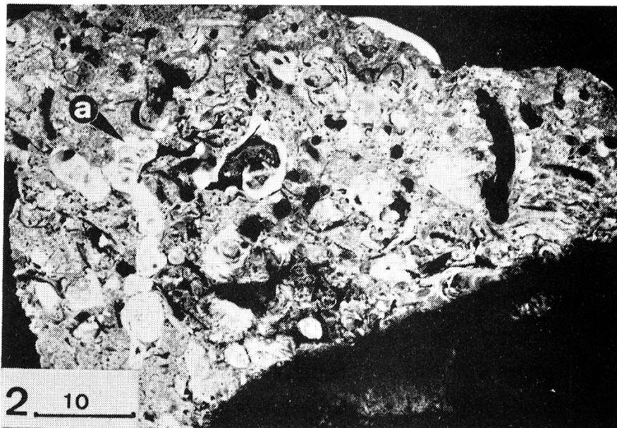
Figure 3- 63 : Section polie d'une calcarénite à Corallinacées pliocène. Les Algues calcaires (a) sont blanches et friables. La roche, perforée est recouverte d'une croûte ferrugineuse (Froget, 1974).
