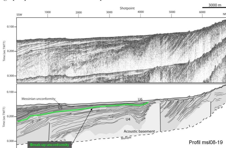
Figure 6-3 : Position de la *break-up unconformity* sur le profil sismique msl08-19 localisée entre 0,15 et 0,22s TWTT et entre 13 et 29 km des côtes de la Nerthe, où la discordance est décrite à l'affleurement. Localisation en fig. 6-6.
