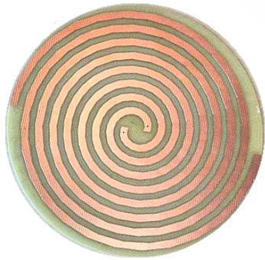
(a) Antenne spirale avec substrat FR4.
