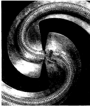
(a) Infinite balun (Dyson, 1959).
