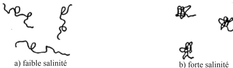
Figure 8 : Effet de la force ionique sur la conformation des chaînes du HPAM (Sorbie, 1991).
