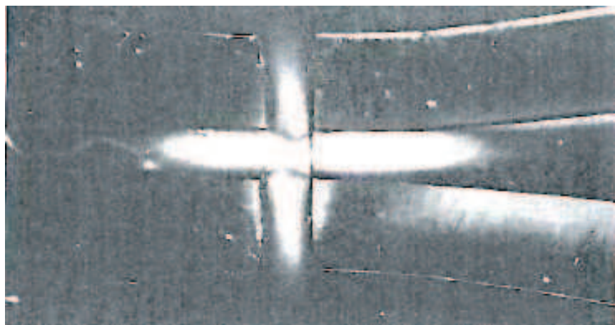
Figure 50 : Cliché de biréfringence caractéristique d'une instabilité de type retour de flamme en écoulement stationnaire d'une solution semi-diluée de polystyrène dans la décaline (Keller et al. , 1987).
