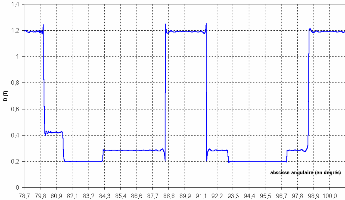
Fig. 2-24 Chute d'induction dans l'entrefer de la machine CEGELEC étudiée. Calcul par décomposition en série de Fourier.
