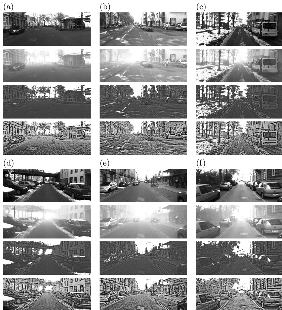
FIGURE 4.23 – Base d’images de Karlsruhe. Dans chaque colonne (a),(b),(c),(d),(e) et (f) nous montrons l’image originale sans brouillard, ajout du brouillard, restauration avec W_s = 11 , G_{s1} = 21 , G_{s2} = 11 , a = 0, 3 , b = 50 et restauration globale du contraste pour une meilleur visibilité.
