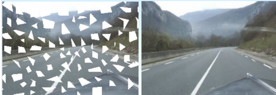
FIGURE 5.19 – Image originale avec les zones à remplir en blanc et le résultat d’“inpainting”. Par rapport à la méthode de Telea, nous obtenons une meilleure reconstruction des différentes structures de l’image
