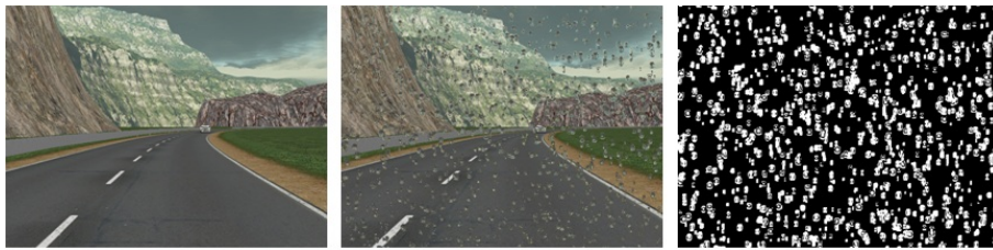
FIGURE 3.5 – Images originale, avec des gouttes de pluie simulée et masque des gouttes
