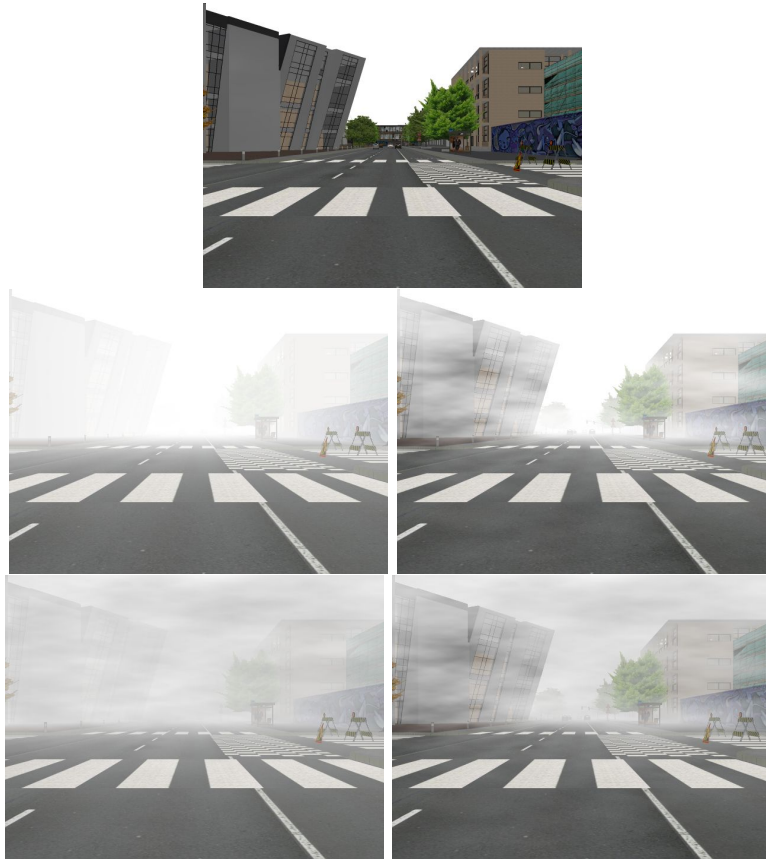
FIGURE 3.3 – Image de synthèse originale et les différents types de brouillards : uniforme, \beta variable, I_\infty variable et \beta et I_\infty variables
