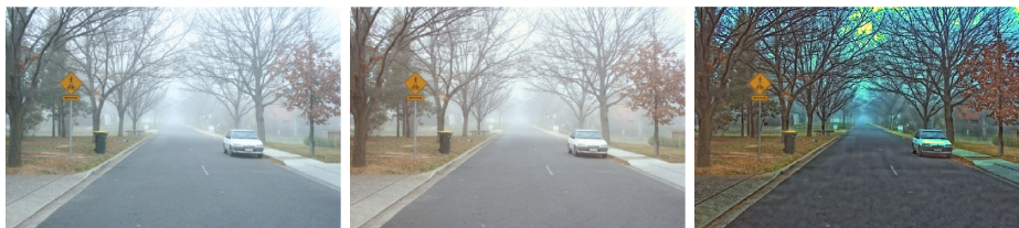
FIGURE 4.4 – Image originale, à gauche ; Image après balance des blancs par modification d'histogramme, au centre ; Image restaurée en estimant l'intensité du ciel comme le maximum sur toute l'image, à droite
