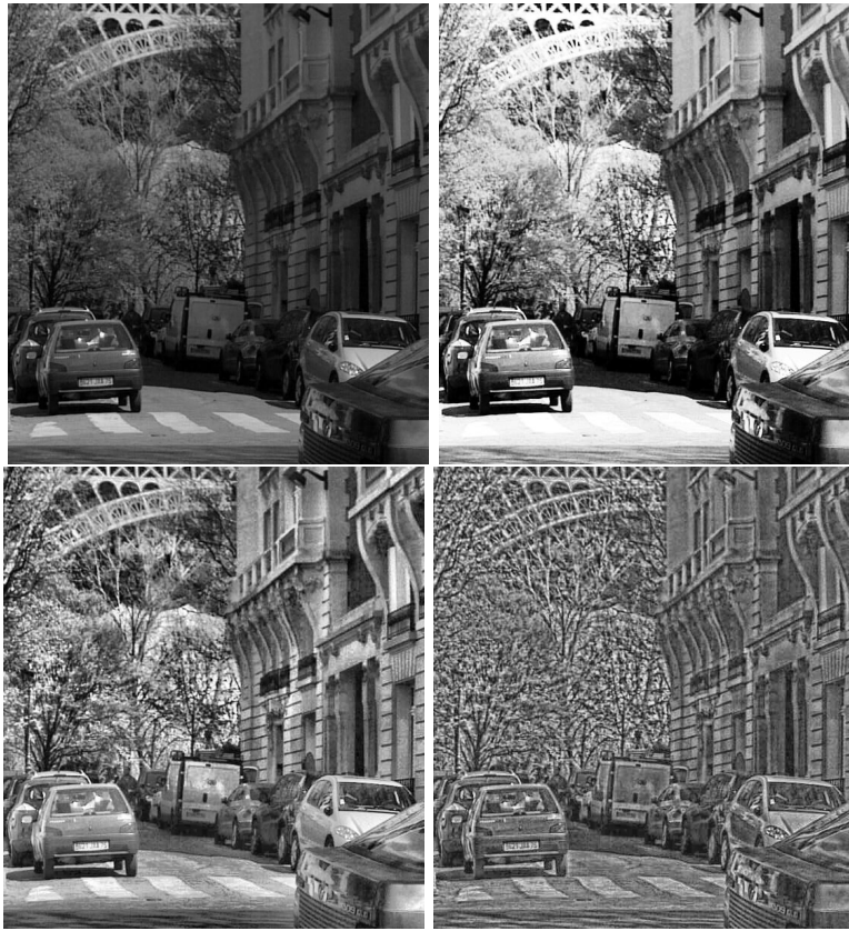
FIGURE 2.9 – Première ligne : image originale et résultat après l'égalisation de l'histogramme. Deuxième ligne : résultats obtenues avec CLAHE pour différentes tailles de fenêtre
