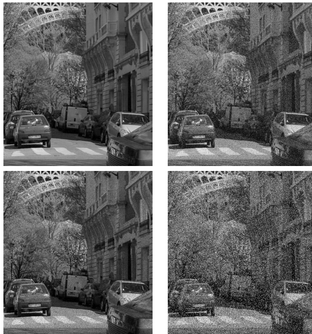
FIGURE 2.3 – En haut à gauche, image originale ; en haut à droite, bruit gaussien additif de moyenne nulle et variance 0,025 ; en bas à gauche, bruit multiplicatif de moyenne nulle et variance 0,05 ; en bas à droite, bruit poivre et sel couvrant 20 % de l'image
