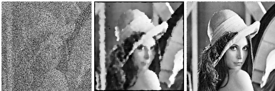
FIGURE A.7 – Image originale bruitée à 80%, débruitage à l'aide d'un filtre médian et débruitage en utilisant l'"inpainting".
