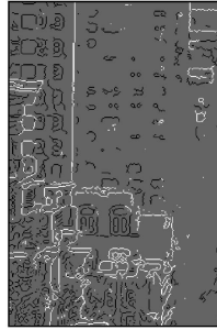
FIGURE 2.20 – Détection des variations de profondeur et de luminosité. En blanc, les contours correspondant à une variation de profondeur. En noir, les contours correspondant à une variation de luminosité.
