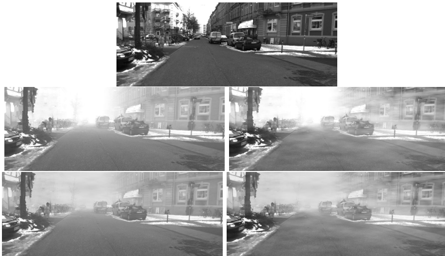
FIGURE 3.6 – Image originale en haut. De gauche à droite et de haut en bas, les différents types de brouillards ajoutés : brouillard uniforme, \beta variable, I_\infty variable, \beta et I_\infty variables
