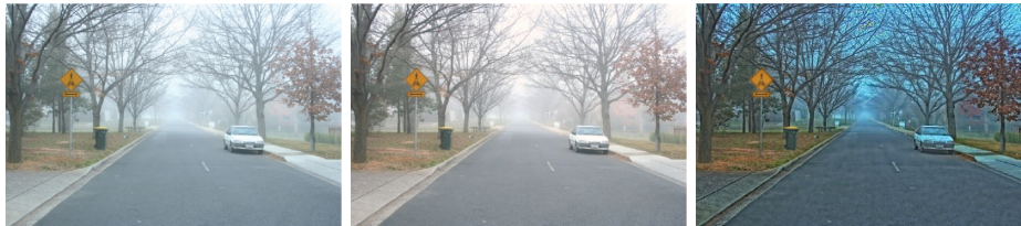
FIGURE 4.3 – Image originale, à gauche ; Image après balance des blancs, au centre ; Image restaurée en estimant l'intensité du ciel comme le maximum sur toute l'image, à droite
