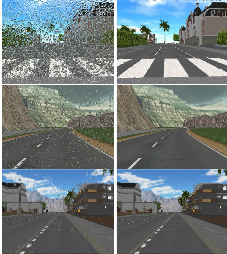
FIGURE 5.22 – Image de pluie et restauration tel que \varepsilon = 9 , \kappa = 70 , \sigma = 1,4 et \rho = 7 . Première ligne : environ 60 % de données manquantes. Deuxième et troisième lignes : environ 10 % de données manquantes.
