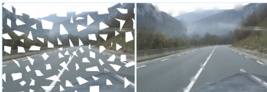
FIGURE 5.13 – De gauche à droite : image originale avec les zones à remplir en blanc et image restaurée par diffusion isotropique rapide [Richard 2001] : convolutions successives par un noyaux gaussien
