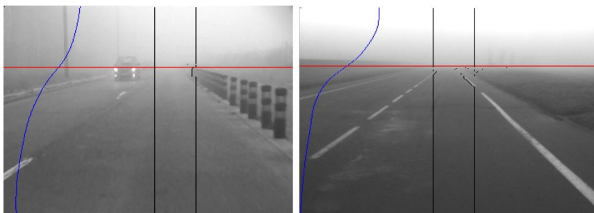
FIGURE 2.28 – Détection du point d'inflexion.
