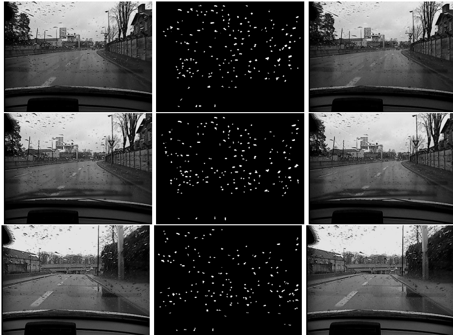
FIGURE 5.20 – De gauche à droite : image originale, masque des gouttes et résultats d’“inpainting” tel que \varepsilon = 3 , \kappa = 7, 8 , \sigma = 0, 5 et \rho = 2, 7
