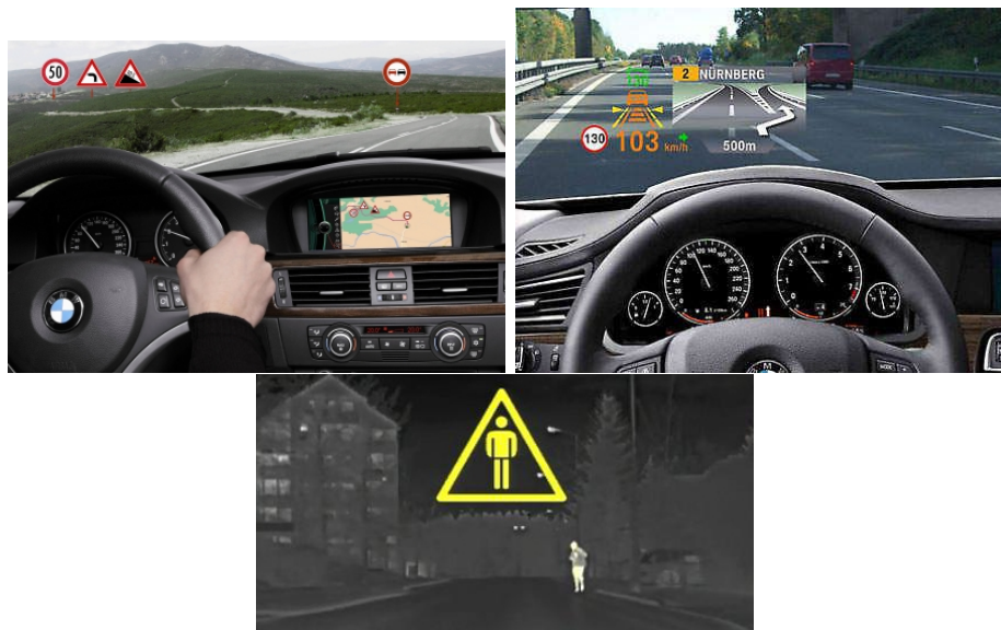
FIGURE 1.2 – En haut, à gauche, système de reconnaissance des panneaux à l'aide d'une caméra et d'un GPS ; projection sur le pare-brise et/ou sur le système de navigation. En haut, à droite, affichage tête haute : informations sur la route ainsi que des instructions et des avertissements. En bas, détection de piétons par caméra infrarouge.
