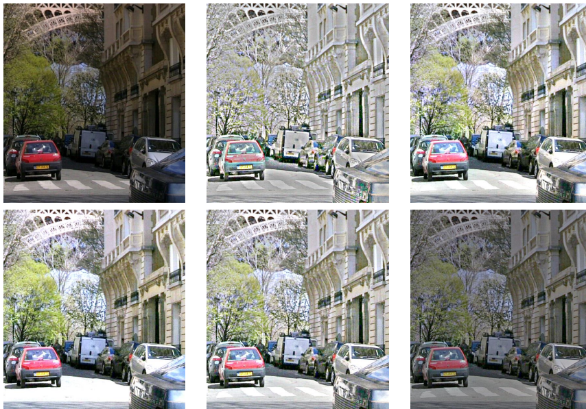
FIGURE 2.10 – De gauche à droite et de haut en bas : image originale, Retinex avec un noyau \sigma = 15 , Retinex avec un noyau \sigma = 80 , Retinex avec un noyau \sigma = 250 , Retinex multi-échelles [15 80 250] et résultat final après normalisation
