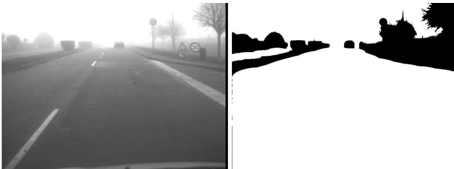
FIGURE 3.7 – Image avec brouillard et masque de la route
