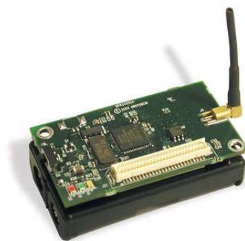
FIGURE 2.15 – Exemple de microcontrôleur : capteur MicaZ
