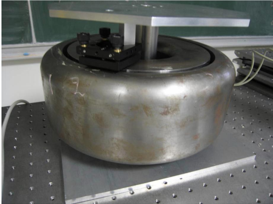
Figure 5.7: Plateau tournant du LISV monté sur l'aimant de test.
