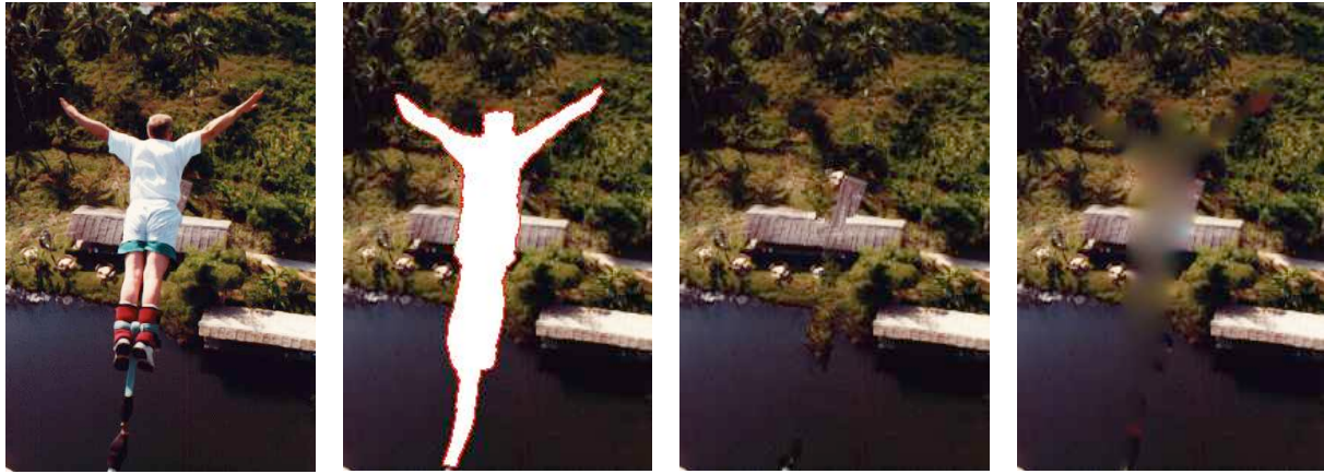
FIGURE 3.8 – Comparatif de deux méthodes de suppression de larges régions dans une image. De gauche à droite : image d'origine, masque désignant la portion à supprimer, résultat de la méthode de Criminisi et al. ([50]), résultat de la méthode de Bertalmio et al. ([23]).
