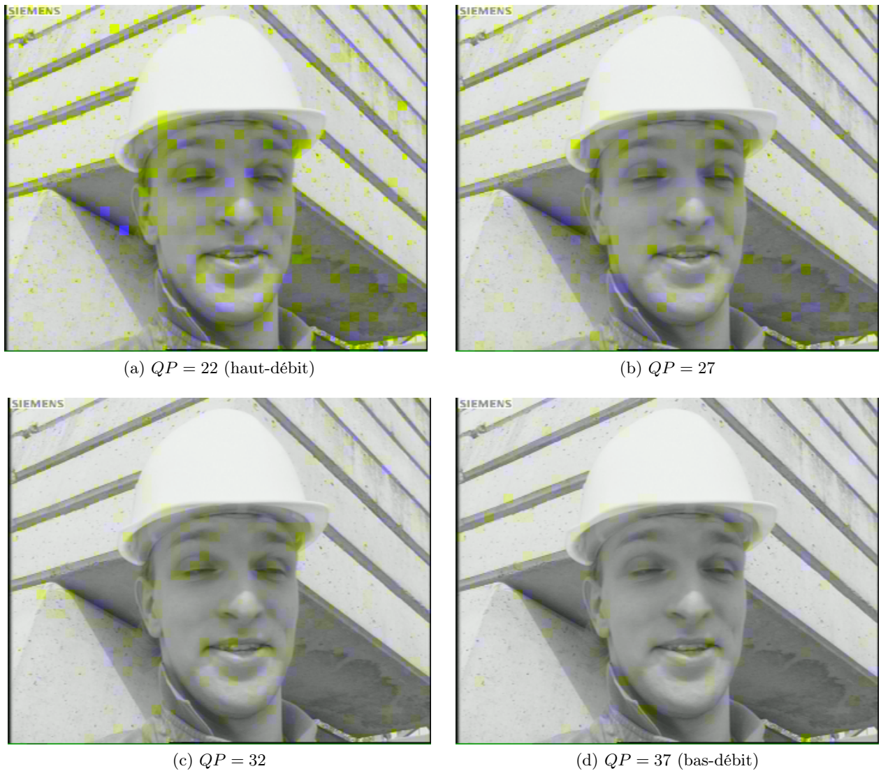
FIGURE 6.14 – Résultats obtenus sur la première image de la séquence Foreman . En vert : les blocs où la prédiction intra-bloc réduit le nombre de symboles codés par rapport à H.264/AVC. En bleu : lorsque le nombre de symboles codés augmente. Plus l'intensité chromatique est élevée, plus la différence est importante.
