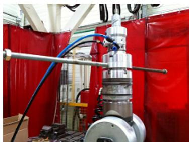
FIGURE 5.7 – Tige filetée porteuse des charges.
