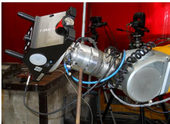
FIGURE 5.15 – T-Mac fixé sur le changeur d’outils.
