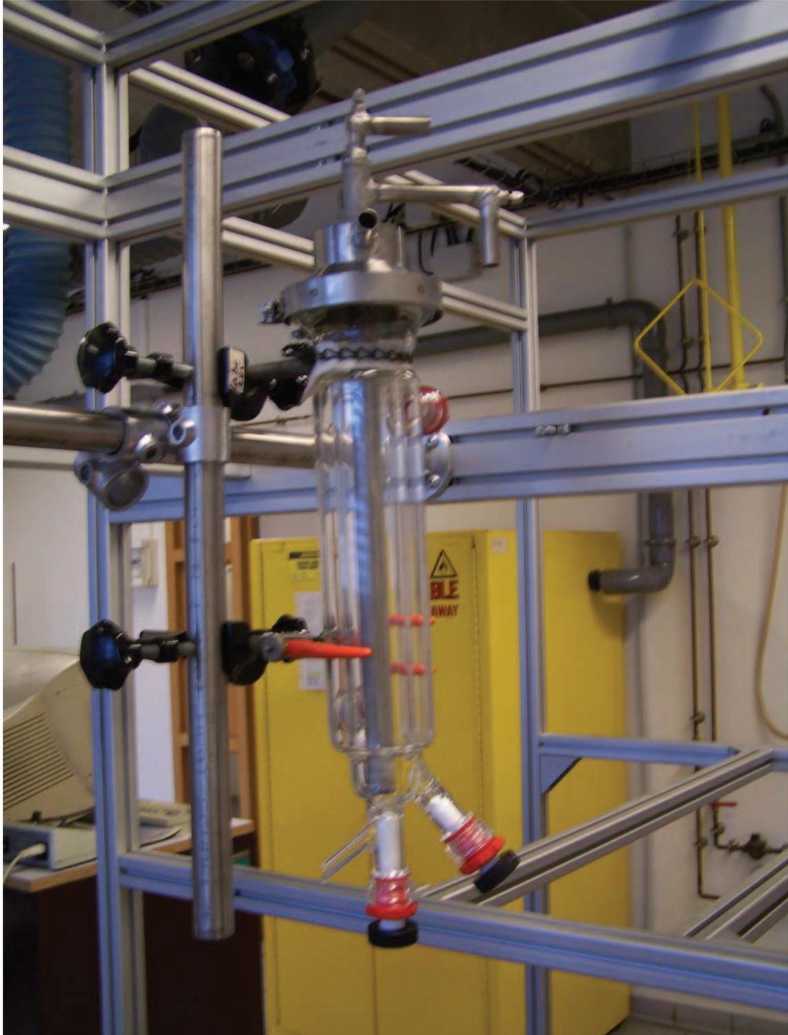
Fig. A.1 : Photographie du pilote expérimental composé du doigt de gant et une cuve en verre.
