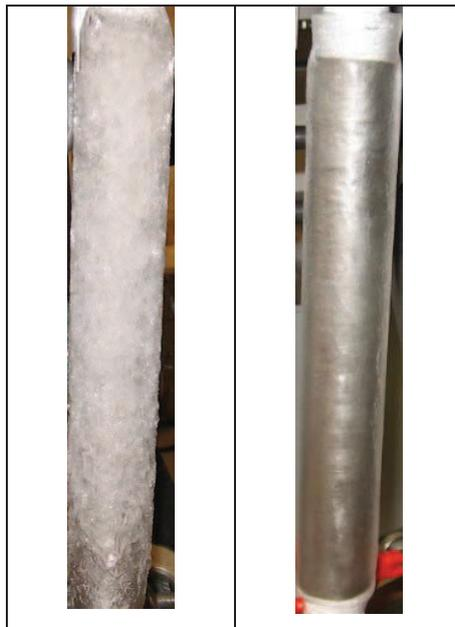
Fig. II.9: Aspect visuel de la couche de glace obtenue pour  $C_i=35\text{g/kg}$  ; a) à gauche en absence de gradient thermique ; b) avec un gradient thermique de  $\Delta T=2,2^\circ\text{C}$
