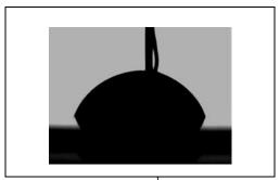
Figure 80: Image d'une goutte de NaCl 0,25 mol L<sup>-1</sup> déposée sur la surface d'un film de PPy-pTs.
