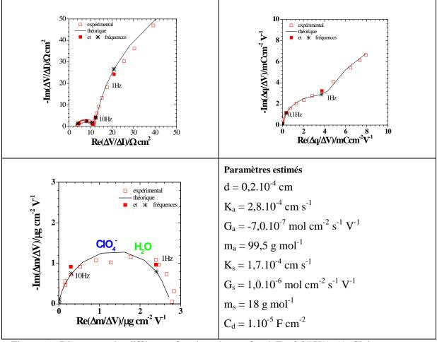
Figure 66 : Diagramme des différentes fonctions de transfert à E = 0.25 V/Ag/AgCl dans une goutte de  $2.5 \,\mu\text{L}$  de  $\text{LiClO}_4 \, 0.25 \, \text{mol L}^{-1}$ ,  $\text{LiCl 1 mmol L}^{-1}$
