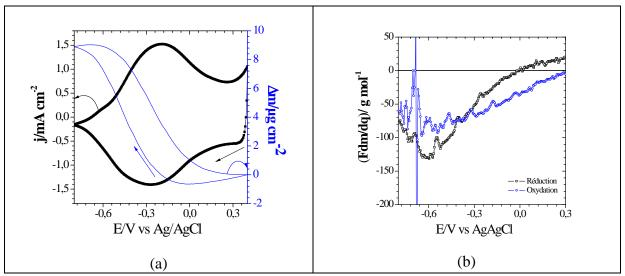
Figure 83 : Courbe d'électrogravimétrie cyclique (a) et variations de Fdm/dq (b) du film de PPy-Tiron dans NaCl 0,25 mol L<sup>-1</sup>. Vitesse de balayage 50 mV/s.
