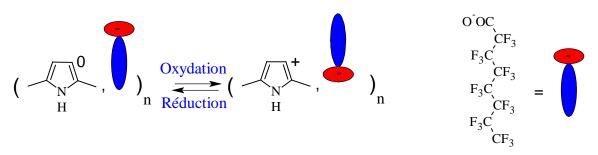
Figure 90: mécanisme de la réorganisation de l'anion dopant au sein du film PPy-PFO
