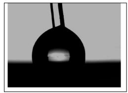
Figure 63: Photographie d'une goutte de solution électrolytique LiCLO<sub>4</sub> 0,25 mol L<sup>-1</sup>, LiCl 1 mM déposée sur la surface d'un film de PPy-C8.
