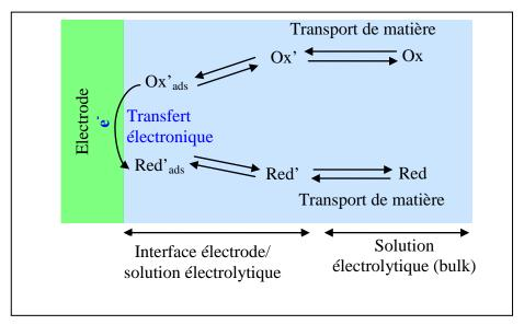
Figure 21 : Différentes étapes d'une réaction électrochimique.
