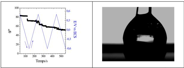
Figure 68: Variations de l'angle de contact d'une goutte de 2,5 μL de LiClO<sub>4</sub> 0,25 mol L<sup>-1</sup>, LiCl 1 mmol L<sup>-1</sup> déposée sur un film PPy-PyFc pour une vitesse de balayage de 10 mV/s, (b) image d'une goutte de solution aqueuse déposée sur la surface du copolymère Py-PyFc enregistré sans polarisation
