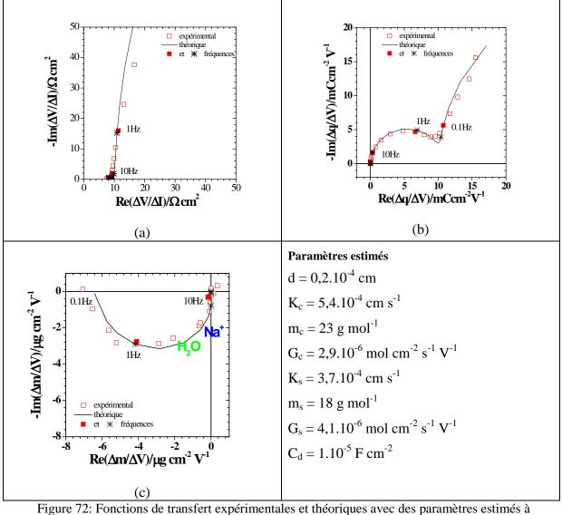
Figure 72: Fonctions de transfert expérimentales et théoriques avec des paramètres estimés à E = -0.45 V/AgAgCl dans NaCl 0.25 mol L<sup>-1</sup>.
