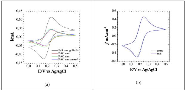
Figure 38 : Comparaison en bulk et en goutte de l'électroactivité du Fe(CN)<sub>6</sub><sup>3-</sup>/ Fe(CN)<sub>6</sub><sup>4-</sup> 5mM, KCl 0,5 mol L<sup>-1</sup>. (a) voltampérogrammes à v=10mV s<sup>-1</sup> du courant absolu; (b) voltampérogrammes à v=10 mV s<sup>-1</sup> de la densité de courant en bulk et en goutte avec la contre électrode Pt enroulé.
