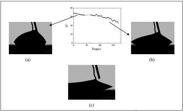
Figure 76: Variation de l'angle de contact d'une goutte de NaCl 0,25 mol L<sup>-1</sup> sur la surface du film de PPy-DBS à un potentiel imposé de - 0,4V/AgAgCl.
