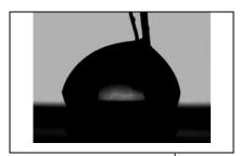
Figure 74: Image d'une goutte de NaCl 0,25 mol L<sup>-1</sup> déposée sur un film de PPy-DBS.
