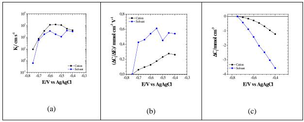
Figure 73 : Paramètres caractéristiques  $K_i$ ,  $\Delta C_i$ ,  $\Delta C_i$ / $\Delta V$  pour un film de PPy-DBS dans une solution aqueuse de NaCl 0,25 mol L<sup>-1</sup>
