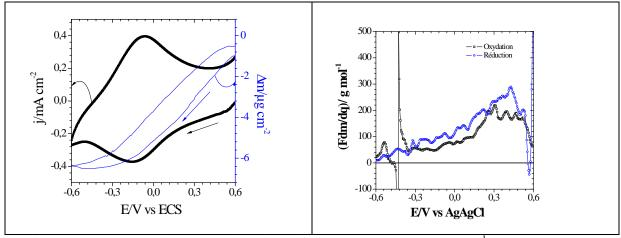
Figure 65: (a) Courbe d'électrogravimétrie cyclique du PPy- $C_8$  à v = 50 mV s<sup>-1</sup> dans une goutte de 2,5  $\mu$ L de LiClO<sub>4</sub> 0,25 mol L<sup>-1</sup>, (b) Variations de la fonction Fdm/dq.
