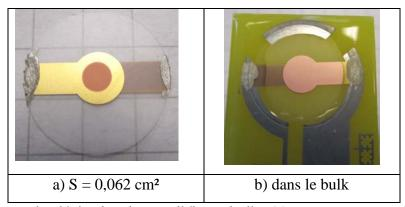
Figure 44 : Images des dépôts de cuivre sur l'électrode d'or (a) pour une goutte et (b) en solution.
