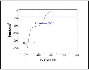
Figure 41: Variation du courant selon le potentiel imposé à l'électrode d'or d'une microbalance dans une solution de CuSO<sub>4</sub>/H<sub>2</sub>SO<sub>4</sub> 0,5 mol L<sup>-1</sup>; vitesse de balayage de 2 mV s<sup>-1</sup>.
