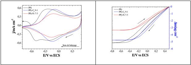
Figure 47: Courbes d'électrogravimétrie cyclique des films de PPy dans LiClO<sub>4</sub> 0,25 mol L<sup>-1</sup>, variation du courant en fonction du potentiel (à gauche), variation de la masse en fonction du potentiel (à droite) ; Vitesses de balayage 50 mV/s.
