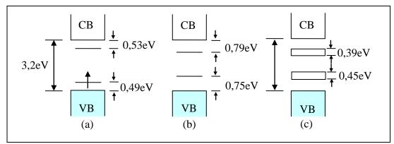
Figure 15 : Evolution de la structure des bandes énergétiques du polypyrrole en fonction du dopage.
