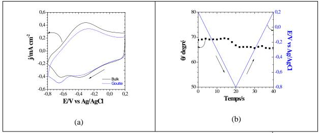
Figure 57 : a) Comparaison des voltampérogrammes dans le bulk (LiClO<sub>4</sub> 0,25 mol L<sup>-1</sup>) et dans la goutte (LiClO<sub>4</sub> 0,25 mol L<sup>-1</sup>, LiCl  $10^{-3}$  mmol L<sup>-1</sup>) à v = 50 mV s<sup>-1</sup> (à gauche), b) Variation de l'angle de contact d'une goutte de 1,5  $\mu$ L de LiClO<sub>4</sub> déposée sur un film PPy pour une vitesse de balayage de 50 mV s<sup>-1</sup> (à droite).
