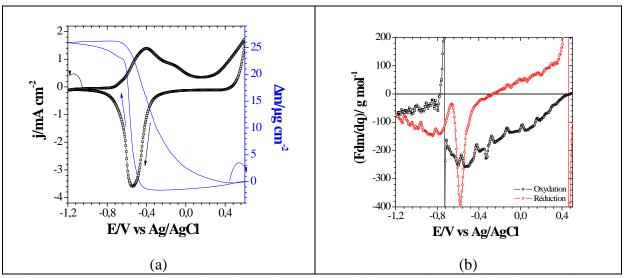
Figure 71: Courbe d'électrogravimétrie cyclique (a) et variation de la fonction *Fdm/dq* (b) du film de PPy-DBS dans NaCl 0,25 mol L<sup>-1</sup>. Vitesse de balayage 50 mV/s.
