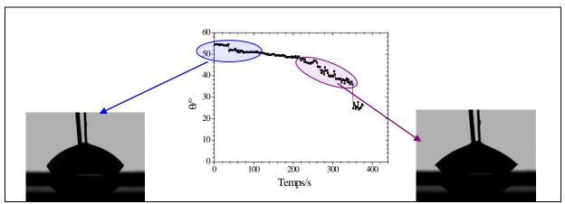
Figure 62: Variations de l'angle de contact au potentiel E = -0.55 V/AgAgCl, V = 2.5  $\mu$ L, LiClO<sub>4</sub> 0.25 mol  $L^{-1}$ , LiCl 1 mmol  $L^{-1}$
