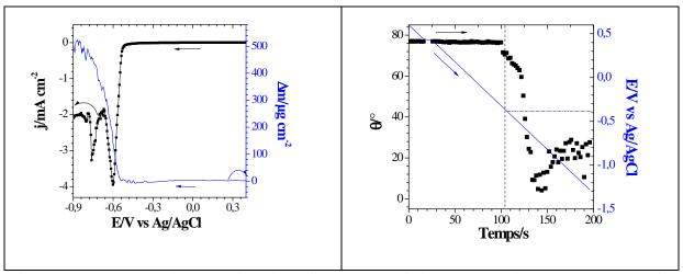
Figure 75: (a) Courbe d'électrogravimétrie cyclique et (b) variation de l'angle de contact et du potentiel en fonction du temps.
