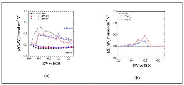
Figure 53: Variations de  $\frac{\Delta C_i}{\Delta V}$  pour les trois films avec le potentiel ((a) anion et solvant, (b) cation).
