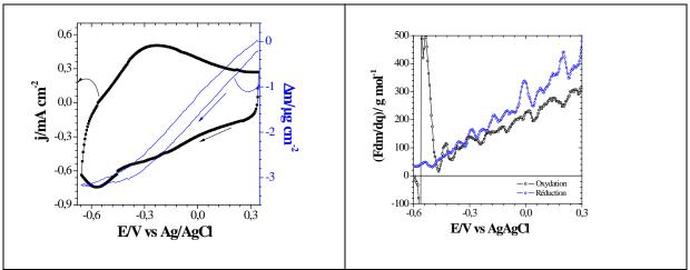
Figure 59: Courbe d'électrogravimétrie cyclique (à gauche) et la variation de *Fdm/dq* (à droite) de la mesure d'une goutte (1,5μL) de solution électrolytique LiClO<sub>4</sub> 0,25 mol L<sup>-1</sup> posée sur la surface du PPy.
