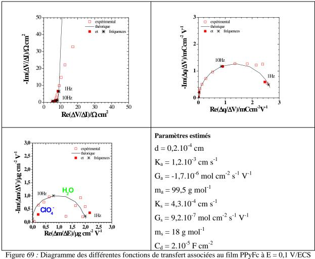
Figure 69 : Diagramme des différentes fonctions de transfert associées au film PPyFc à E = 0.1 V/ECSdans une goutte de 2,5  $\mu$ L de LiClO<sub>4</sub> 0,25 mol L<sup>-1</sup>, LiCl 1mmol L<sup>-1</sup>
