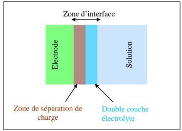
Figure 16 : Schéma illustrant l'interface électrode-solution.
