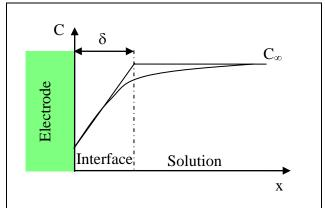
Figure 22 : Profil de concentration simplifié à l'interface de l'électrode.
