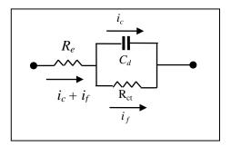
Figure 27: circuit électrique équivalent d'une cellule électrochimique
