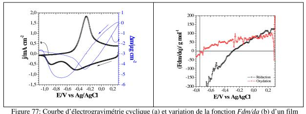
de PPy-pTS dans NaCl 0,25 mol L<sup>-1</sup>. Vitesse de balayage 50 mV s<sup>-1</sup>.
