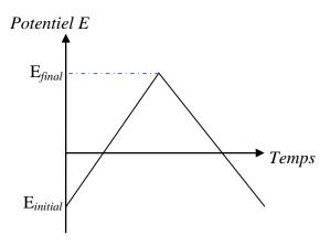
Figure 23: Variation du potentiel en fonction du temps en voltamétrie cyclique.
