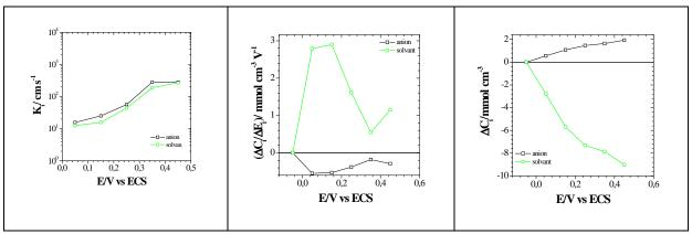
Figure 67: Variations des paramètres caractéristiques  $K_i$ ,  $\Delta C_i/\Delta E$ ,  $\Delta C_i$  pour les mesures dans une goutte de 2,5  $\mu L$  de de LiClO<sub>4</sub> 0,25 mol  $L^{-1}$ , LiCl 1 mmol  $L^{-1}$
