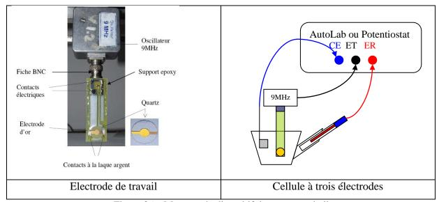
Figure 36: Montage du dispositif de mesure en bulk
