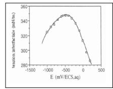
Figure 2 : Courbe d'électrocapillarité de Lippmann
