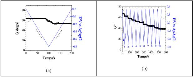
Figure 58: a) Variation de l'angle de contact d'une goutte de  $1,5 \,\mu\text{L}$  de LiClO<sub>4</sub> déposée sur un film PPy pour une vitesse de balayage de  $10 \,\text{mV/s}$  (a) ; b) Variation de l'angle de contact de  $10 \,\text{balayages}$  de  $50 \,\text{mV} \,\text{s}^{-1}$  successifs (b)
