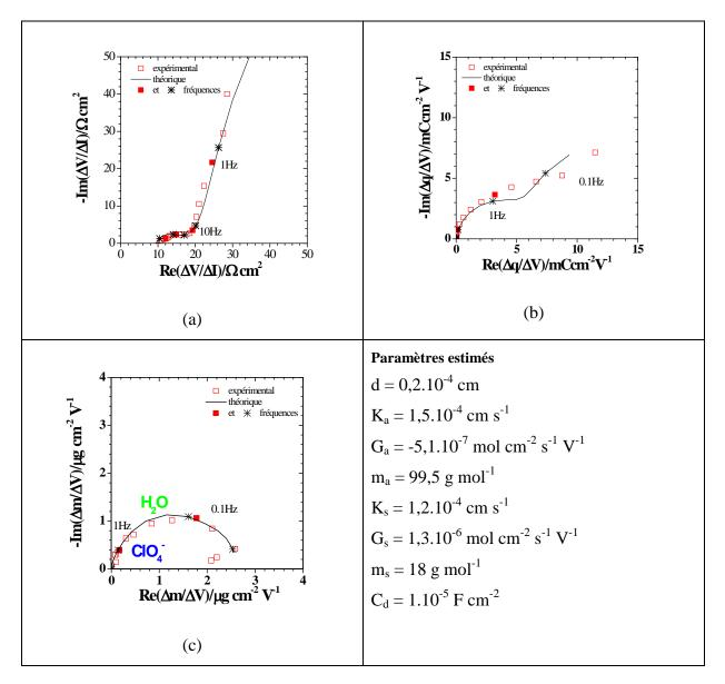
Figure 60 : a-b-c) Diagramme des différentes fonctions de transfert à E = -0.25 V/Ag/AgCl dans une goutte de 1,5  $\mu$ L de LiClO<sub>4</sub> 0,25 mol L<sup>-1</sup>, LiCl 1 mmol L<sup>-1</sup>
