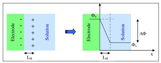
Figure 17 : Modèle de Helmholtz de la double couche.
