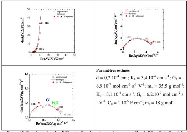
Figure 82: Représentation des différentes fonctions de transfert pour un film de PPy-pTs à E = -0.2 V/AgAgCl, mesurées dans une goutte de solution électrolytique NaCl 0,25 mol  $L^{-1}$  – volume 2,5  $\mu$ L
