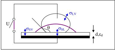
Figure 3 : Dispositif général de mesure d'électromouillage
