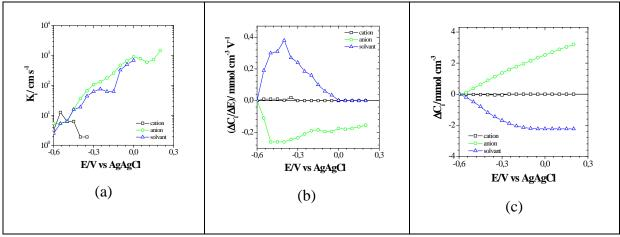
Figure 79: Paramètres caractéristiques  $K_i$ ,  $\Delta C_i$ ,  $\Delta C_i$ / $\Delta E$  associés au film de PPy-pTs dans NaCl 0,25 mol L<sup>-1</sup>
