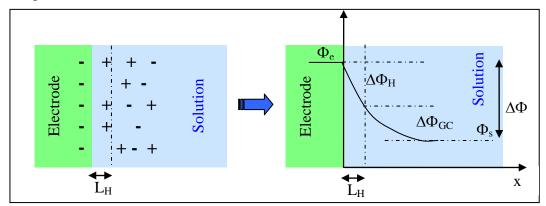
Figure 19 : Modèle de Stern de la double couche.
