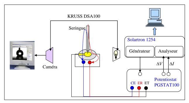
Figure 34 : Dispositif expérimental pour les mesures d'angle de contact couplées avec les mesures d'impédance électrochimique.
