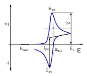
Figure 24: Voltampérogramme pour un système réversible.
