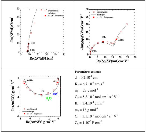
Figure 84: Représentation des différentes fonctions de transfert pour le PPy-tiron dans NaCl  $0.25 \text{ mol L}^{-1}$  à E = -0.3 V/AgAgCl
