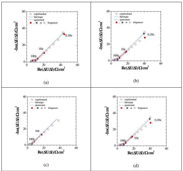
Figure 40 : Diagramme de Nyquist des impédances électrochimiques obtenus avec Fe(CN)<sub>6</sub><sup>3-</sup>/
