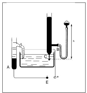
Figure 1 : Description de l'expérience d'électrocapillarité de Lippmann.
