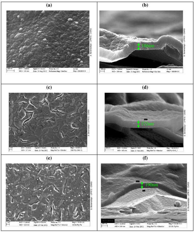
Figure 46 : Photos MEB des films de PPy (a,b) et PPy-fonctionnalisé (c,d : PPy-C<sub>8</sub> et e,f : PPy-Fc). A gauche : vue de surface, à droite: vue en coupe.
