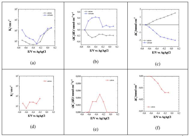
Figure 88: paramètres caractéristiques  $K_i$ ,  $\Delta C_i/\Delta V$ ,  $\Delta C_i$  pour le film PPy-PFO dans NaCl 0,25 mol L<sup>-1</sup>. (a-b-c) pour l'anion et le solvant, (d-e-f) pour le cation
