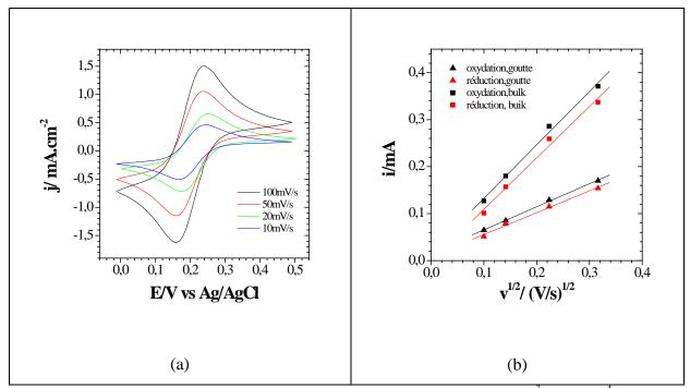
Figure 37 : Voltampérogrammes à différentes vitesses de balayages du  $Fe(CN)_6^{3-}/Fe(CN)_6^{4-}$  5 mmol  $L^{-1}$  en goutte ((a)) et variation du courant en fonction de la racine de la vitesse de balayage ((b)).
