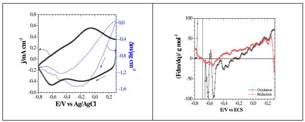
Figure 86: Courbe d'électrogravimétrie cyclique (a) et variations de la masse molaire *Fdm/dq* (b) du film de PPy-PFO dans NaCl 0,25 mol L<sup>-1</sup>. Vitesse de balayage 50 mV/s.
