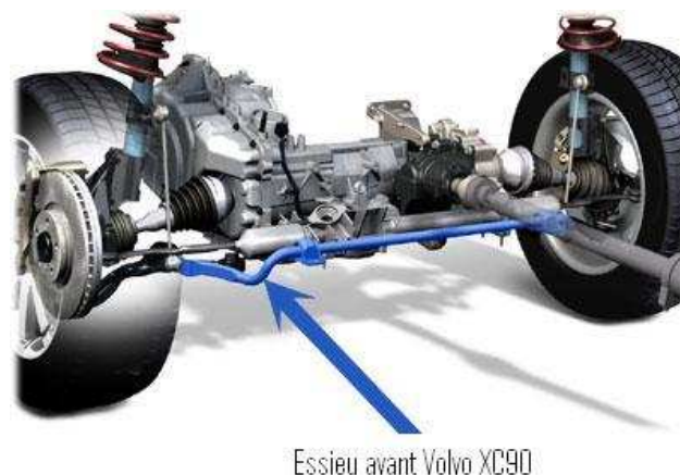
FIGURE 5.2 – Une barre anti-roulis sur l'essieu avant d'une Volvo XC90 [auto ]
