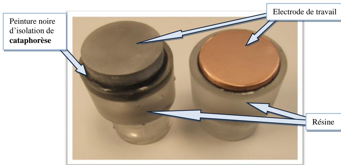
Figure II-2 : Photographie de l'électrode de travail de grand diamètre (30 mm), l'aluminium à gauche et le cuivre à droite.
