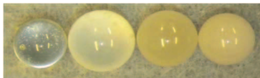
Figure II. 3 Verre parent (à l'extrême gauche) et vitrocéramiques correspondantes obtenues pour des temps de recuit croissants
