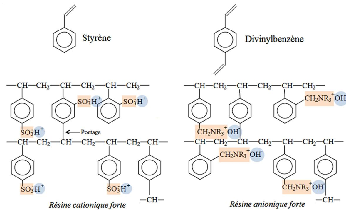
**Figure 25 : Structure d'une résine cationique et d'une résine anionique.** En rouge : les groupes fonctionnels. En bleu : les contre-ions. Chaque pontage est réalisé via un monomère de divinylbenzène.
