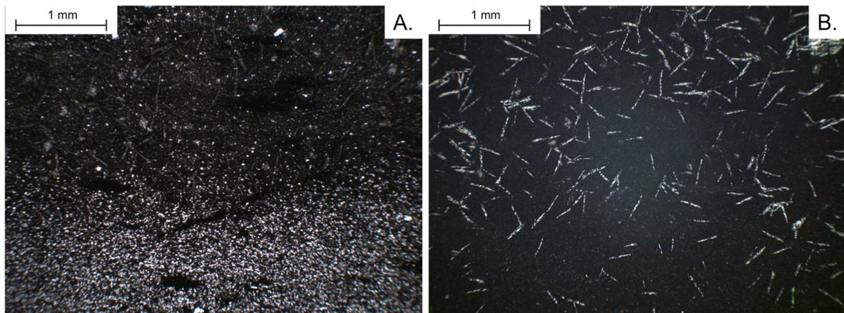
**Figure 47. Microphotographies d'une lame mince de l'échantillon 2.4.** (A) Lumière naturelle. On distingue un horizon clair très quartzeux en bas, bordant un horizon plus sombre, fin et chargé en matière organique en haut. (B) Lumière réfléchie faisant ressortir les spicules. Dans la partie basse correspondant à l'horizon quartzeux, les spicules sont éparées et moins bien conservés pour la plupart, tandis qu'au-dessus les spicules sont omniprésents.
