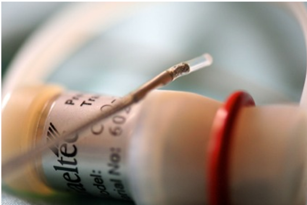
Figure 20 : Extrémité de la sonde équipée de transducteurs pressionnels (Ø 2,1 mm)
