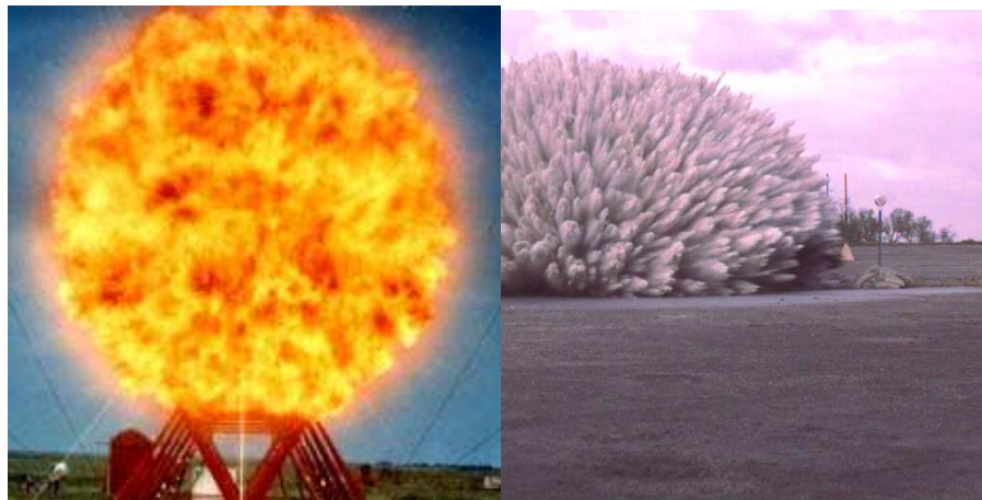
Figure 1.1 A gauche, explosion sphérique formant une boule de feu. A droite, explosion d'une charge entourée d'un lit de sable. Dans les deux cas l'interface présente des perturbations, 'émoussées' dans le cas de gauche ou en forme de véritables jets dans le cas de droite. Ces instabilités d'interface forment des zones de mélange qui augmentent considérablement la zone affectée par les effets de l'explosion.
