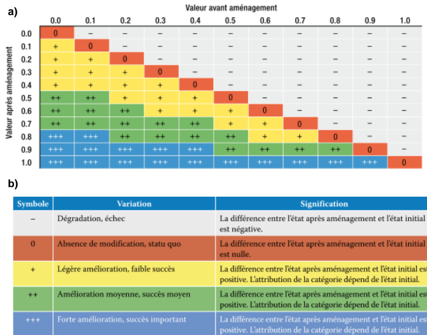
Figure 3.38 : a) Matrice d'évaluation renseignant les couples de valeurs standardisées des indicateurs avant et après travaux. b) Définition des catégories d'amélioration ou de dégradation du site restauré par rapport à son état initial (Woolsey et al. , 2005)
