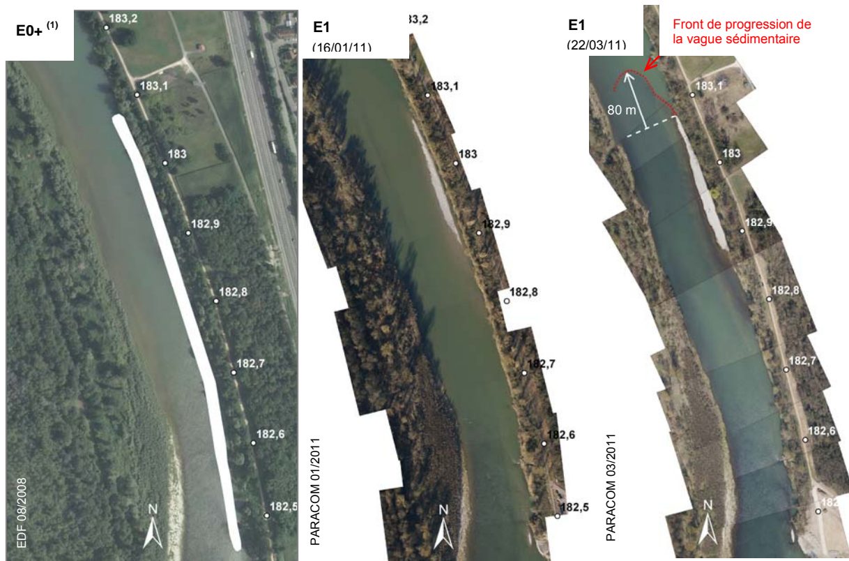
Figure 3.19 : Suivi par imagerie aérienne : le front de progression de la vague sédimentaire est visible sur la vue aérienne du 22/03/2011
