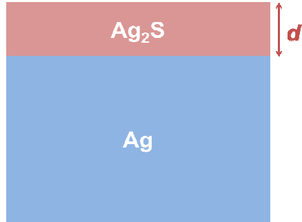
Figure 4.15(a) Représentation de la surface en une couche de sulfure d'argent formée sur l'argent métallique.
