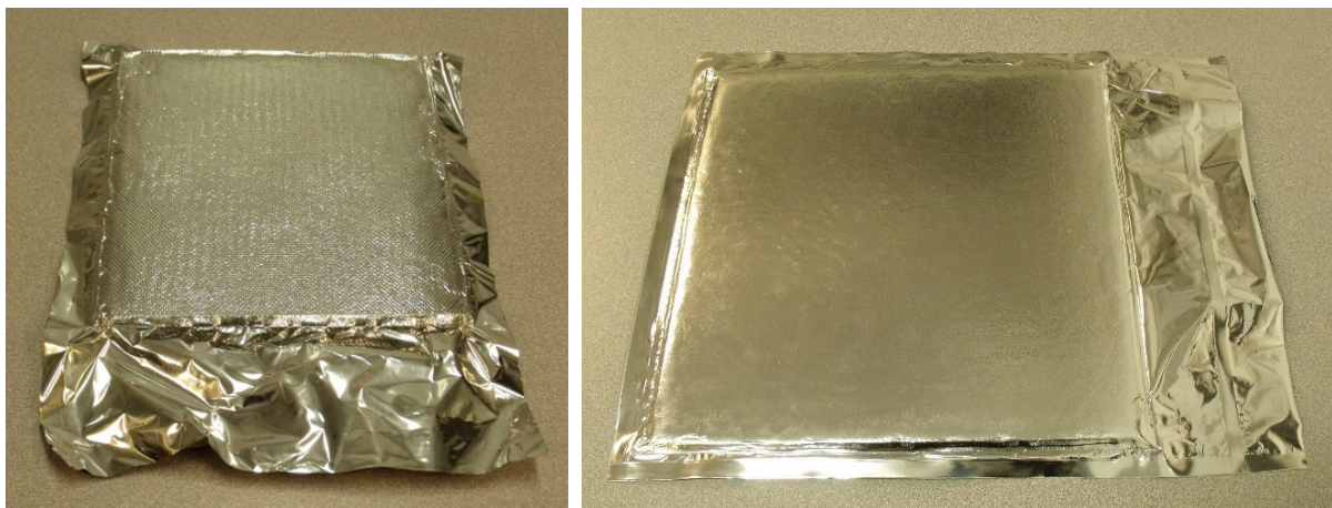
FIGURE 1.7 – Deux spécimens de PIV neufs, avec zone de soudure non repliée (sur tout le pourtour des PIV)
