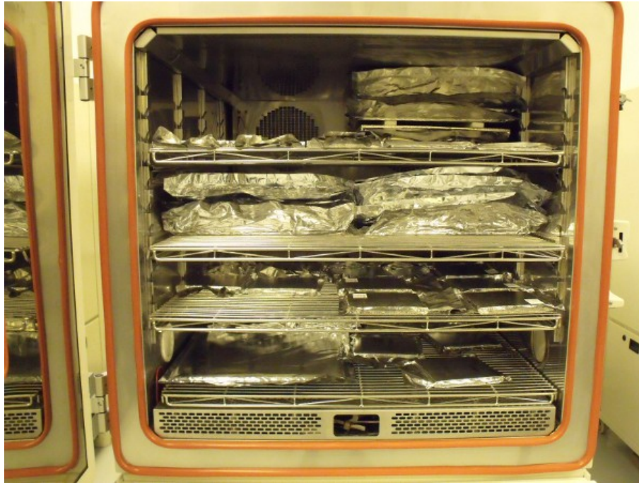
FIGURE 6.4 – Intérieur d’une enceinte climatique prête pour une séquence de vieillissement de PIV, avec différents panneaux sont disposés sur plusieurs niveaux
