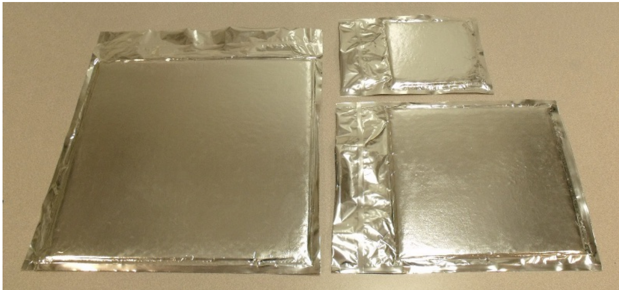
FIGURE 6.3 – PIV ayant la membrane MF8 comme enveloppe utilisés pour les essais de vieillissement en enceinte climatique (taille des panneaux : 20 \times 20 \times 1 \text{ cm}^3 , 35 \times 35 \times 1 \text{ cm}^3 et 50 \times 50 \times 1 \text{ cm}^3 )
