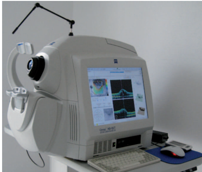
FIGURE 2.14 – Appareil commercial Cirrus HD-OCT de ZEISS, fonctionnant dans le domaine de Fourier
