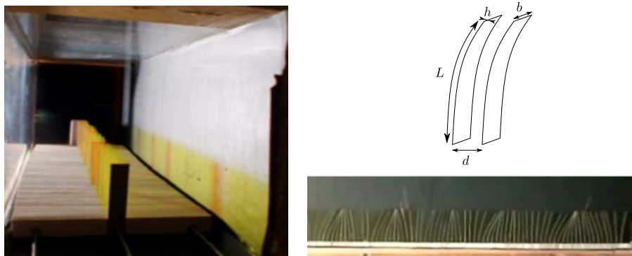
FIGURE 3.1 – Montage expérimental. À gauche, l'assemblée de plaques dans la soufflerie. En bas à droite, les plaques soumises à un écoulement pendant une expérience. En haut à droite, les différents paramètres définissant l'assemblée de plaques flexibles : L leur hauteur, h leur épaisseur, b leur largeur et d leur écartement.
