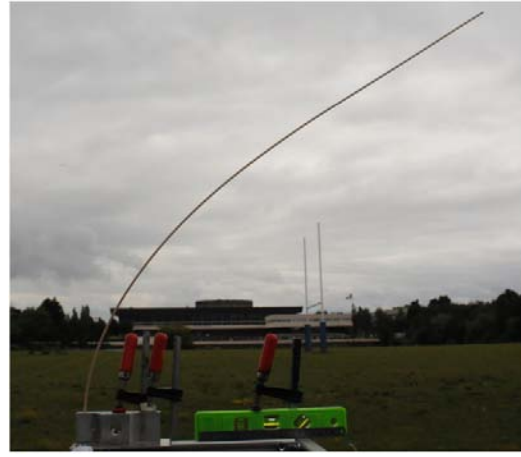
(b) Diamètre de la tige : 4 mm ; longueur de la tige : 960 mm ; vitesse de l'écoulement : 33,3 m/s ; vitesse du vent : 1,8 m/s (relevé Météo France).
