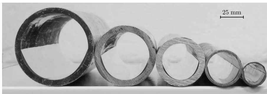
FIGURE 4.8 – Préparation de rubans en Lexan dans des tubes avant le passage au four, afin de leur donner une courbure transversale.
