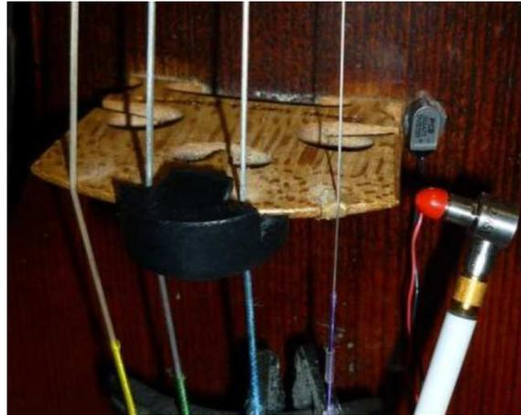
FIGURE 5.17 – Sourdine utilisée pour l'étude, mise en place sur le chevalet du violon. Sa masse est de 1.2 g.
