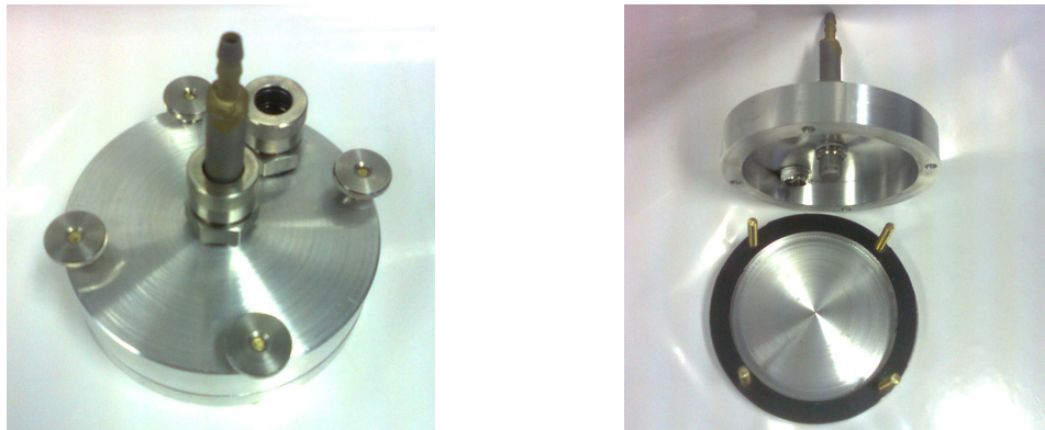
FIGURE 3.3: Notre prototype du DAF. L'étanchéité entre les deux parties est assurée par un joint plat. Du Téflon ® en bande est utilisé pour étanchéifier les orifices filtrés de sortie et d'entrée.
